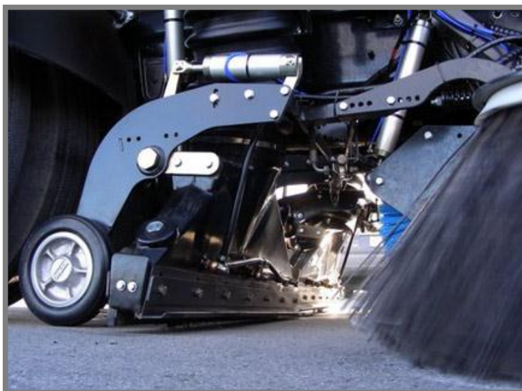
Obr. 10-4 Detail stavitelné kartáčové hlavice u modelu Schwarze A7000
