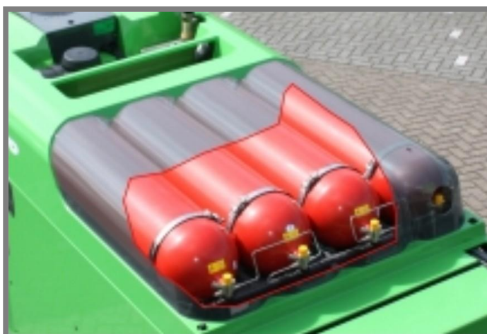
Obr. 10-12 Uložení tlakových lahví na střeše karoserie
