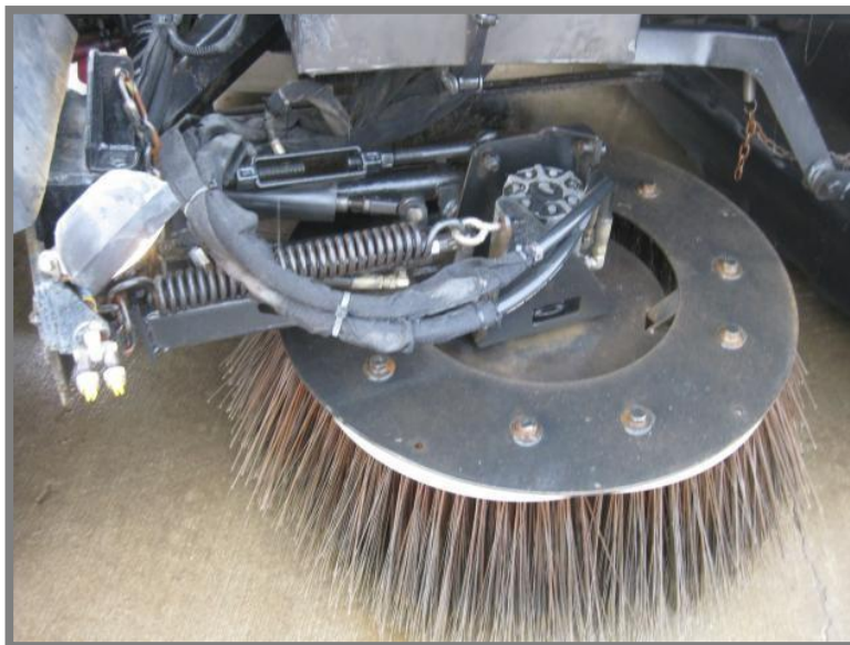
Obr. 10-2 Detail zavěšení rotačního kartáče
