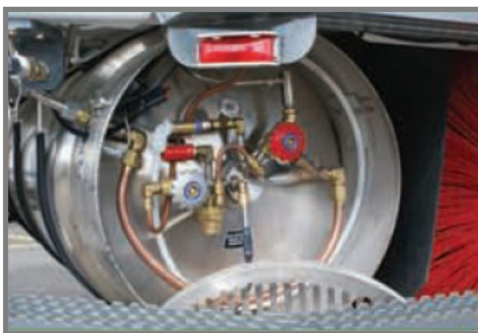
Obr. 10-11 Uložení tlakové láhve na rámu podvozku
