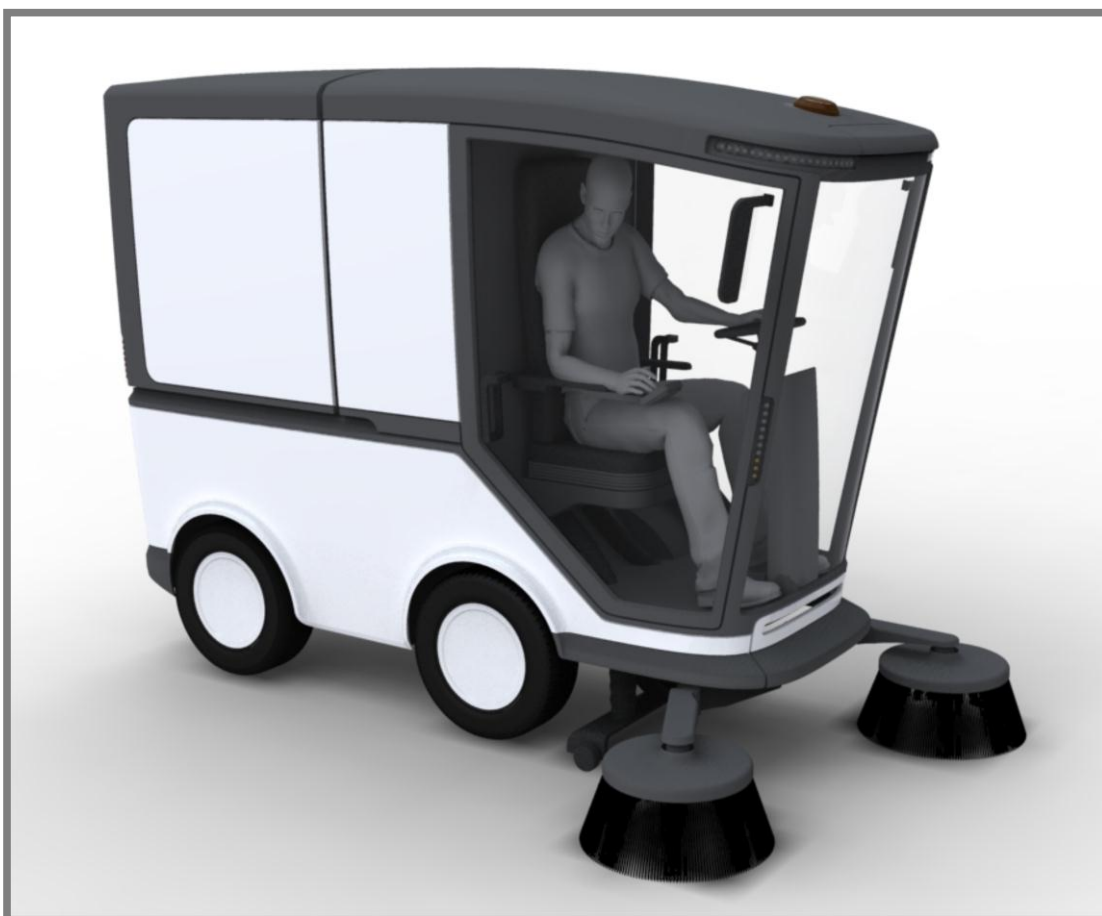
Obr. 13-1 Městská úklidová jednotka v pracovní poloze
