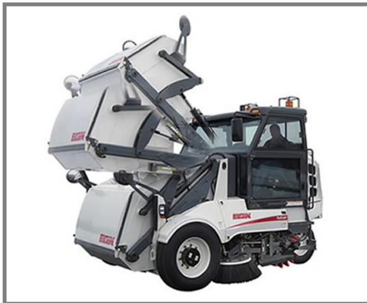
Obr. 10-6 Elgin Pelican, mezní polohy výsypky
