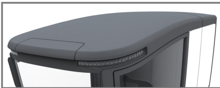
Obr. 14-5 Detail střechy a předních pracovních světel
