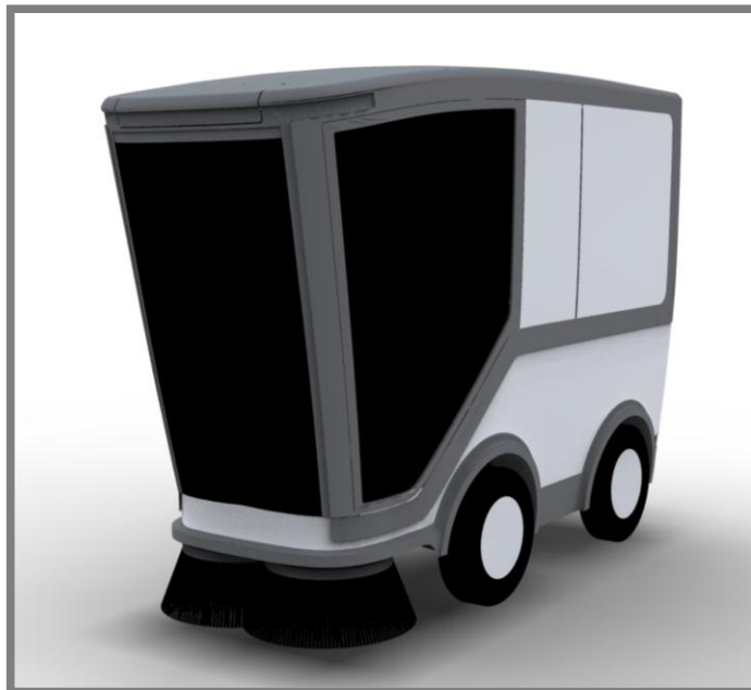
Obr. 12-5 Vývojová fáze II. Změny v přední části, první idea masky
