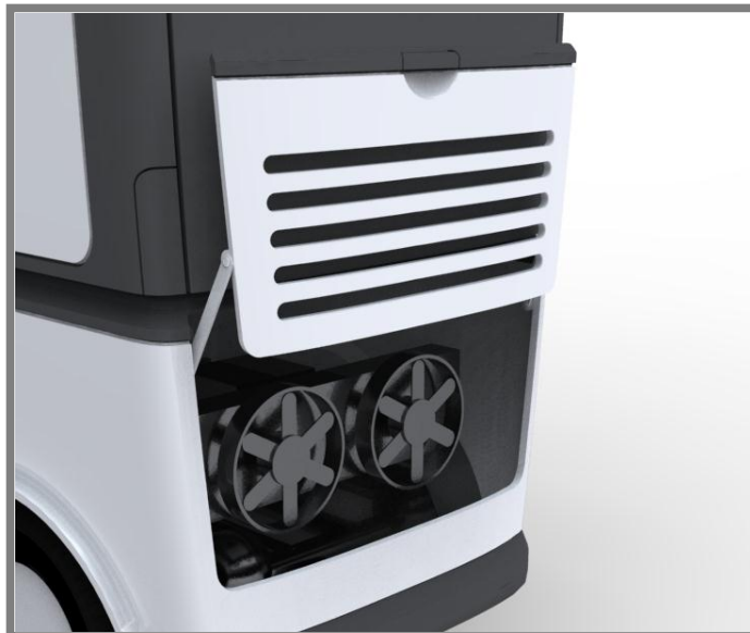
Obr 16-10 Přístup k pohonné jednotce, ventilace
