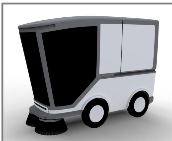
Obr. 12-6 Vývojová fáze III. Vyčleňuje se výsypka, změna v oblasti krytů kol
