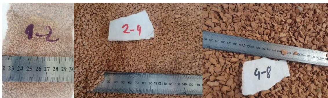
Obr. 9 Fotografie cihelného recyklátu frakce 1-2 mm, 2-4 mm a 4-8 mm
