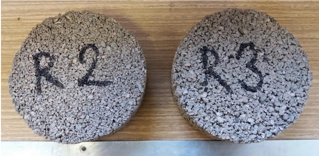
Obr. 19 Zkušební tělesa pro stanovení činitele zvukové pohltivosti
