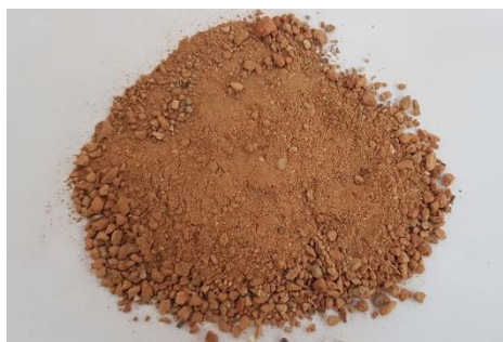
Obr. 1 Cihelný recyklát frakce 0–4 mm [4]
