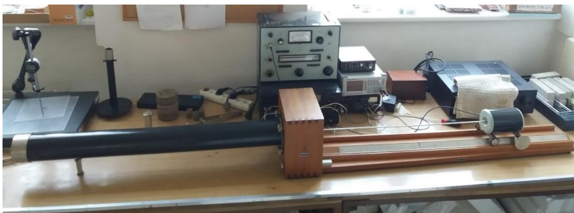
Obr. 15 Kundtova impedanční trubice
