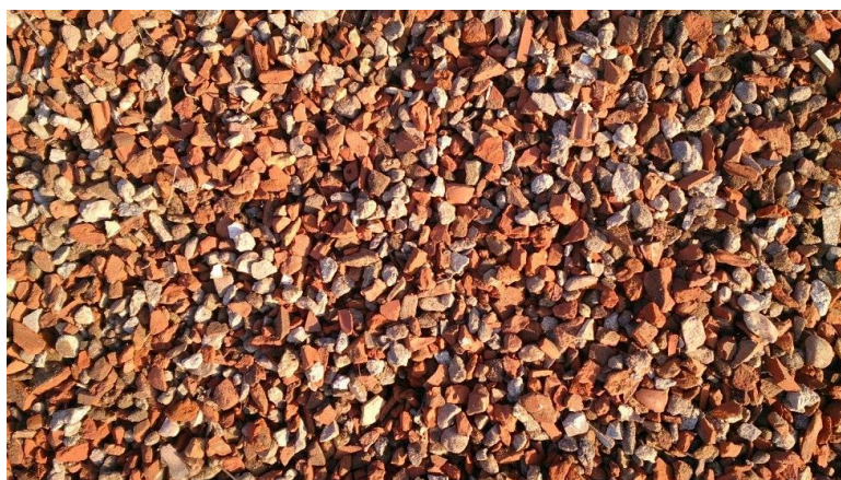
Obr. 7 Hrubý recyklát ze staveništního odpadu [52]
