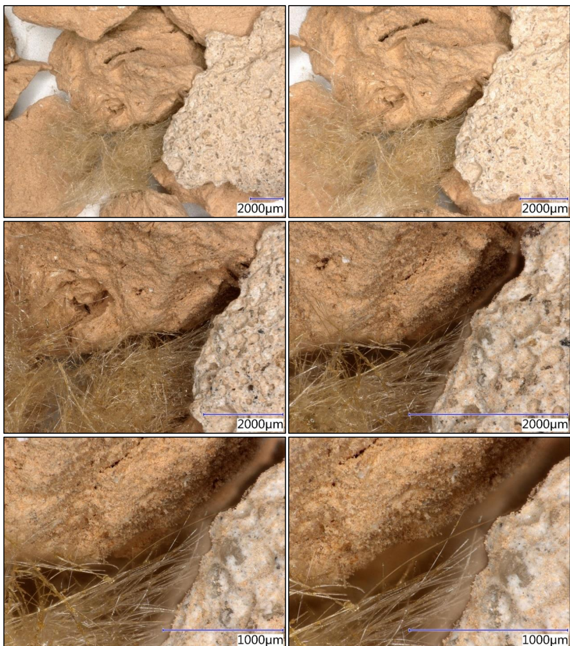
Obr. 16 Cihelný recyklát frakce 4-8 mm - zvětšení 20x, 30x, 50x, 100x, 150x a 200x
