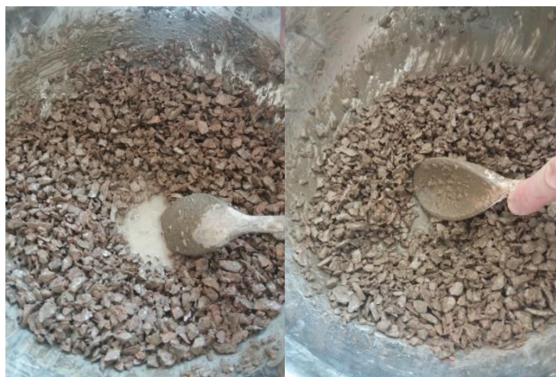
Obr. 10 Čerstvá směs s poměrem frakcí 80:20:0 s cementem v množství 200 kg a 150 kg
