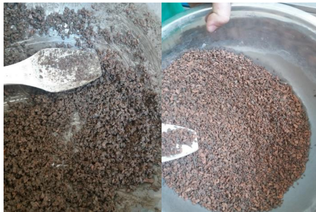
Obr. 12 Čerstvá směs s poměrem frakcí 0:70:30 s cementem v množství 150 kg a 100 kg
