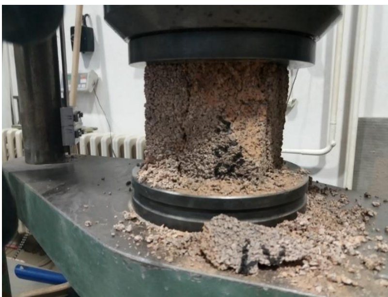
Obr. 14 Porušení tělesa při stanovení pevnosti v tlaku po 28 dnech
