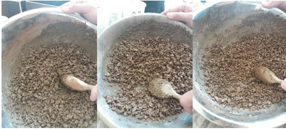
Obr. 11 Čerstvá směs s poměrem frakcí 60:30:10 s cementem v množství 200 kg, 150 kg a 100 kg
