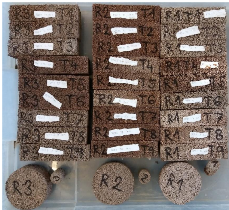
Obr. 13 Zkušební tělesa receptur 5, 6 a 7 po odformování
