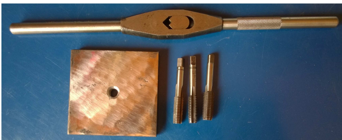
Obr. 2.2 Výroba vnitřního závitu sadovým závitníkem.
