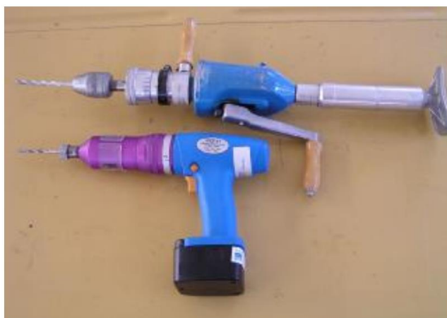
Obrázek 31 Ruční a elektrická Kučerova vrtačka
