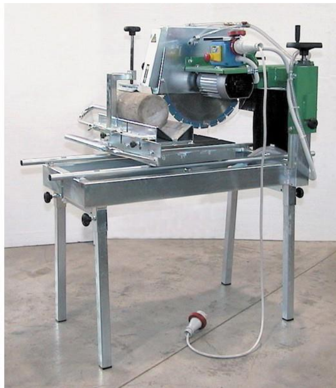
Obrázek 4 Kotoučová pila pro zakoncování zkušebních těles [15]
