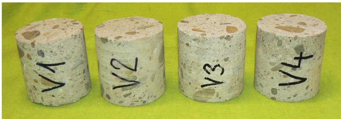
Obrázek 51 Nařezaná zkušební tělesa V1, V2 pochází z průvlaku v 2NP a tělesa V3, V4 jsou ze sloupů 1NP
