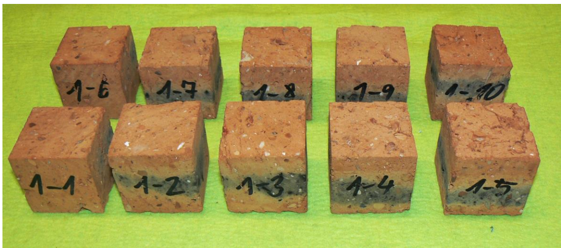
Obrázek 80 Celkem 10 zkušebních těles bylo vyřezáno z cihly č.1
