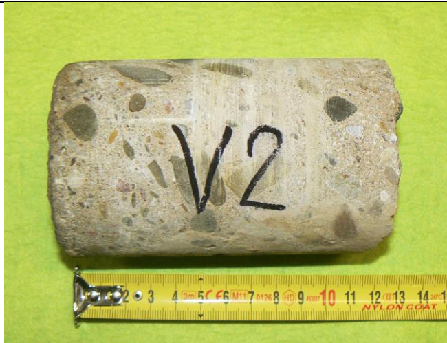
Obrázek 50 Foto odebraného vývrtu V2
