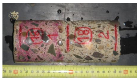
Obrázek 3 chemické reakce po aplikaci 1% roztoku fenolftaleinu
