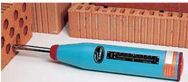
Obrázek 29 Schmidt LB pro cihelné zdivo [21]
