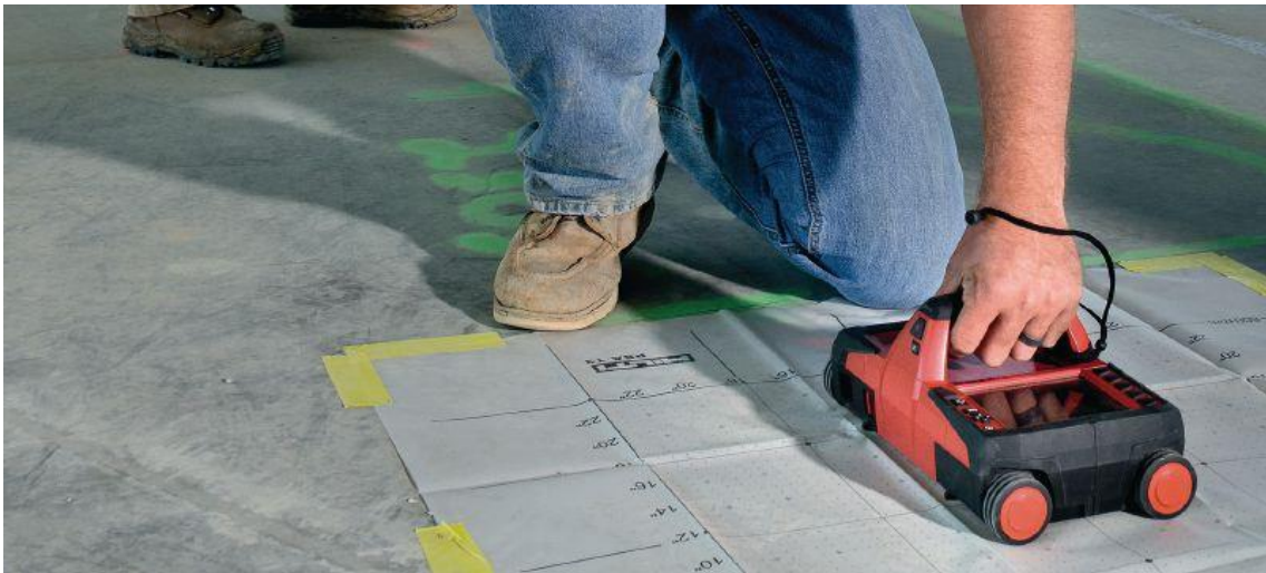
Obrázek 25 Příklad provádění plošného skenu
