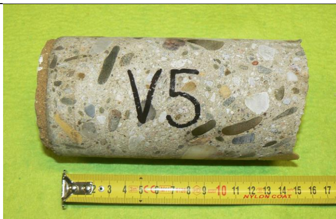
Obrázek 41 Foto na odebraný vývrt V5 ze sloupu S1-
