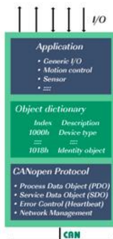
Obrázek 3.10 Vnitřní architektura CANopen, převzato z [16].
