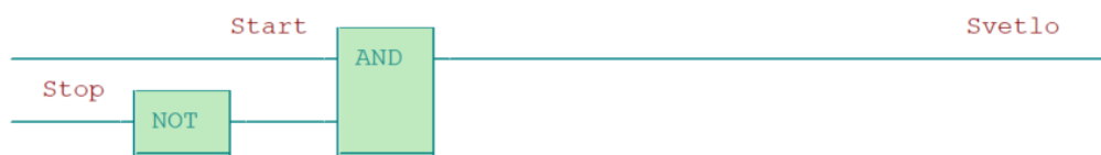
Obrázek 2.2 Příklad programu v jazyku funkčních bloků vytvořený v programu Mosaic.
