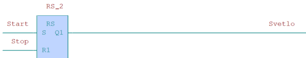
Obrázek 2.3 Stejný příklad programu v jazyku funkčních bloků při uvažování vstupů jako tlačítek vytvořený v programu Mosaic.
