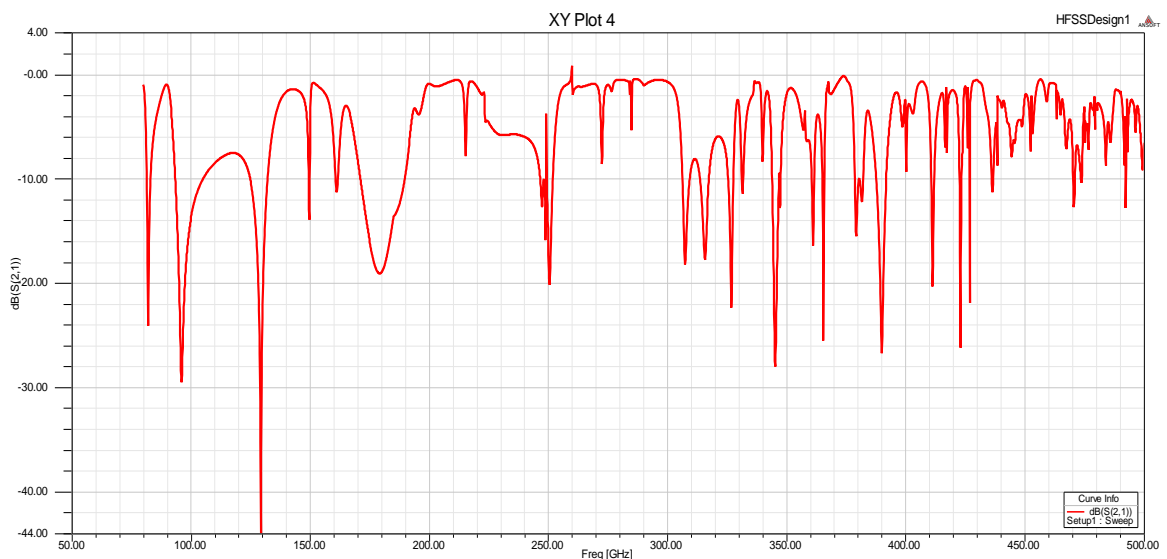
Obr. 3.3 Graf parametru S_{21} pro frekvence 80 GHz až 500 GHz s minimálním frekvenčním krokem 0,1 GHz s použitím interpolační metody. Řešeno pro referenční model ( t = 0,01 \text{ mm} , h = 1,5 \text{ mm} , R = 0,6 \text{ mm} , d = 0,1 \text{ mm} , r = 0,4 \text{ mm} , w = 0,1 \text{ mm} ).
