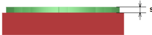
Obr. 3.29 Boční pohled na model a definování šířky prstence.
