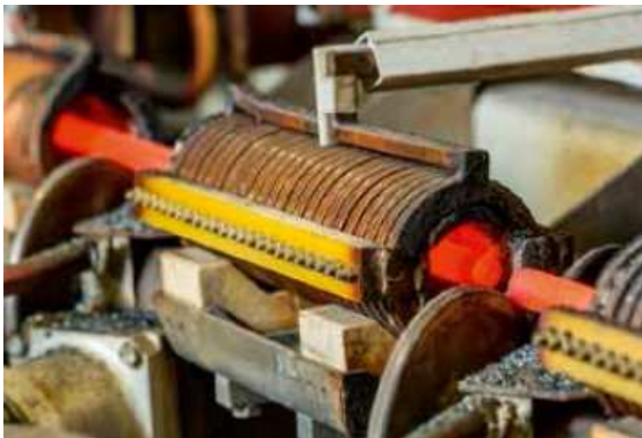
Obr. 2.6 Trubková tyč procházející sérií cívek [7].
