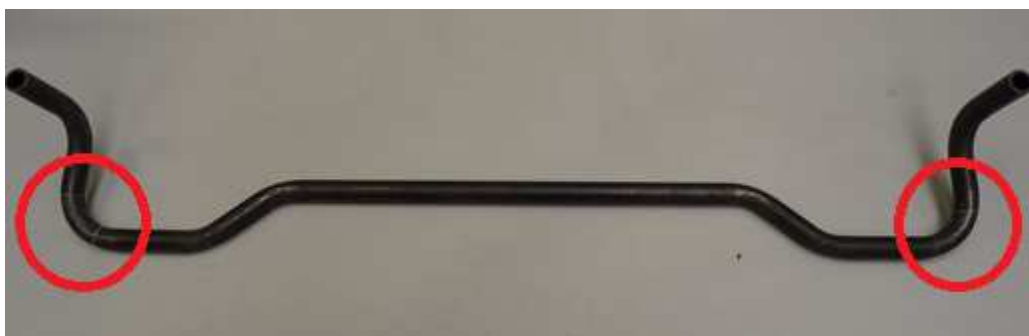
Obr 4.5 Kritické oblasti z hlediska zbytkové napjatosti.
