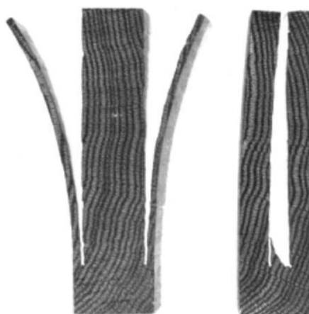
Obr. 3.2 Chování materiálu po provedení řezu [16]
