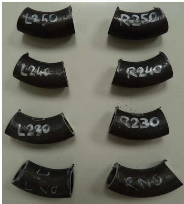
Obr 4.6 Vzorky po odřezání ze stabilizátorových tyčí.
