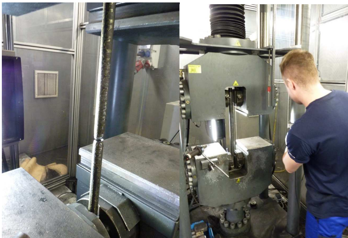
Obr 4.11 Tahová zkouška a operace stroje Zwick/Roell.
