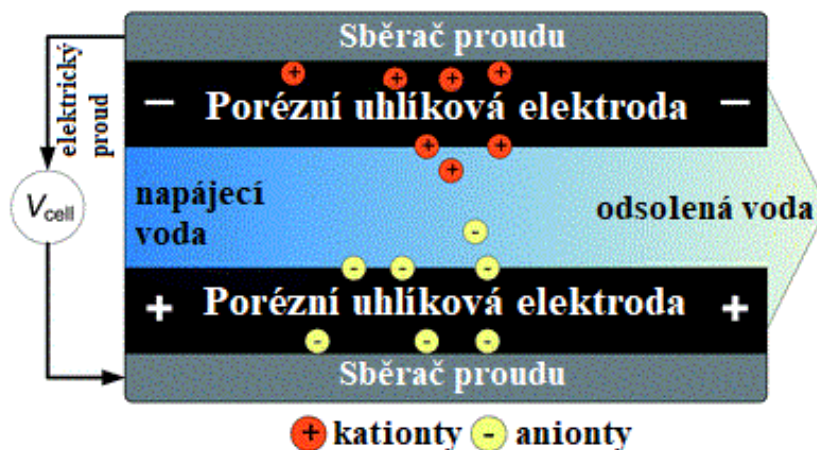
Obrázek 4: Adsorpce iontů na pórovitou uhlíkovou elektrodu [upraveno dle 1]
