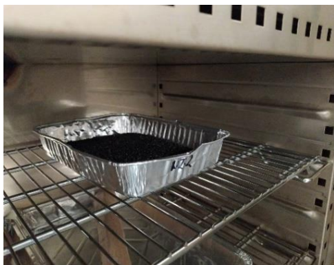
Obr. 21 a) Hliníková miska s rozprostřeným silikagelem v laboratorní sušárna Venticell 111 b) Laboratorní sušárna Venticell 111 nastavená na regenerační teplotu 105 °C.
