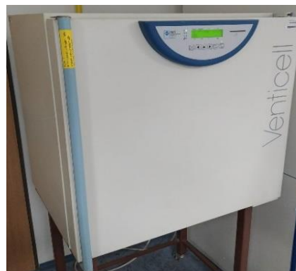
Obr. 21 a) Hliníková miska s rozprostřeným silikagelem v laboratorní sušárna Venticell 111 b) Laboratorní sušárna Venticell 111 nastavená na regenerační teplotu 105 °C.
