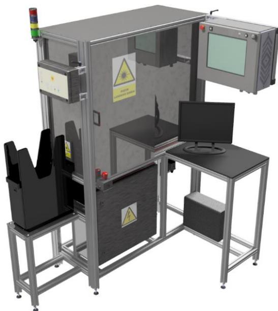
Obrázok 9: Zariadenie na laserové značenie [30]
