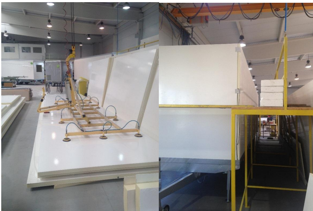
Obrázek 7: Usazování panelů na podvozek (Zdroj: Vlastní zpracování).
