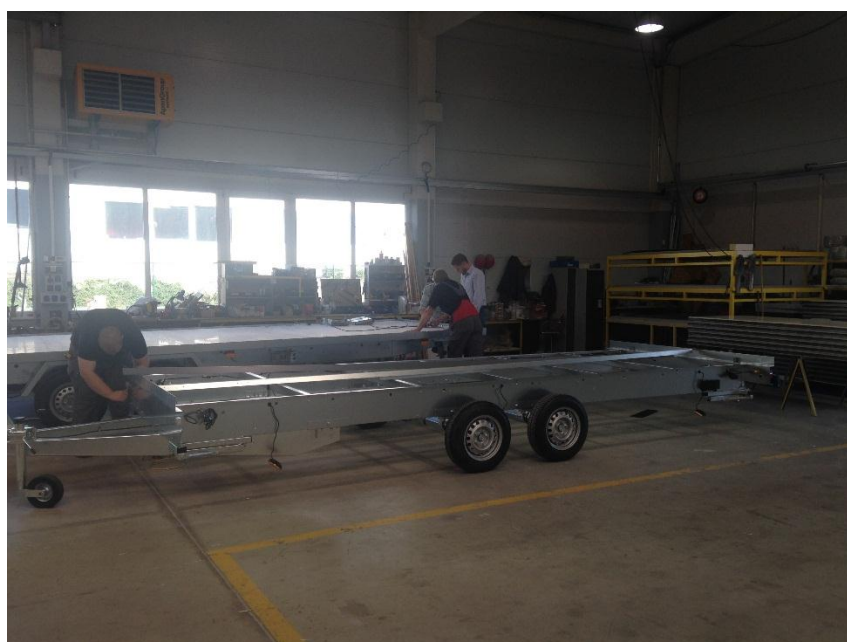
Obrázek 6: Montáž podvozku (Zdroj: Vlastní zpracování).
