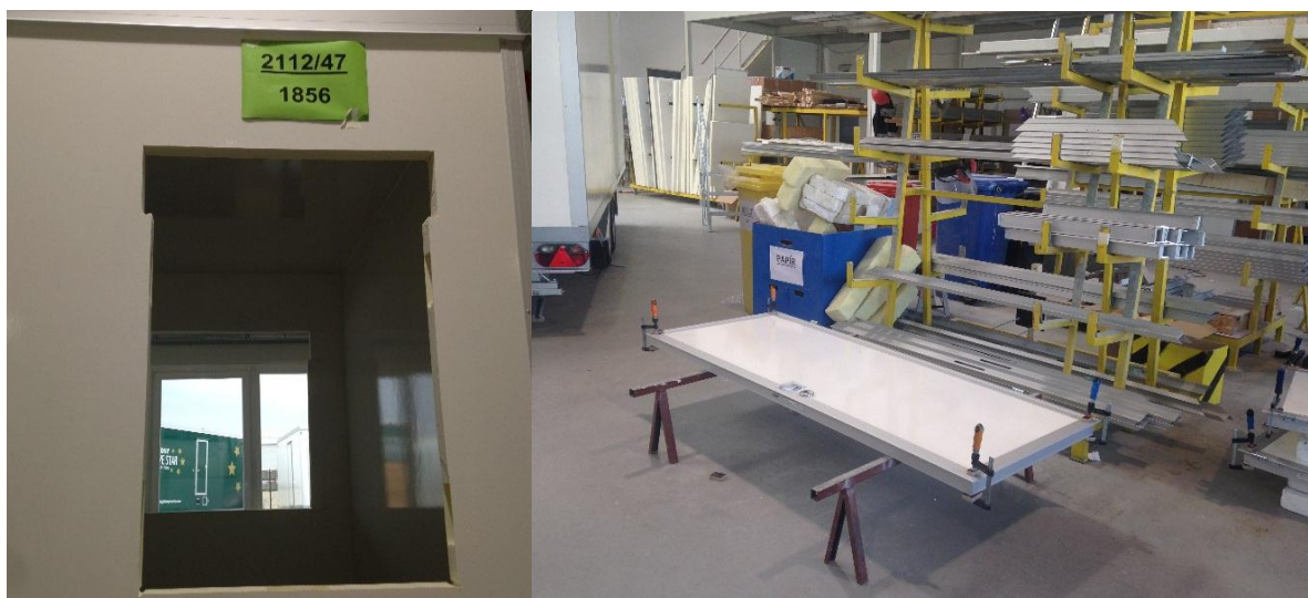
Obrázek 8: Výřez dveří, oken a následné usazení (Zdroj: Vlastní zpracování).
