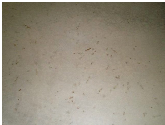
Obr. 6: Příklad rozvoje plošné koroze drátků
