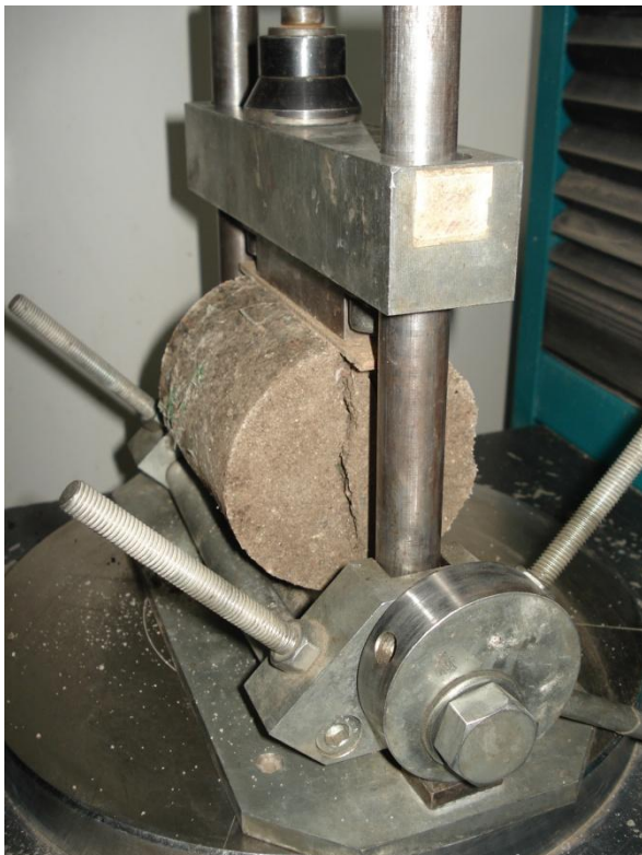
Obrázek 24 Porušení směsi bez rozpadu vzorku
