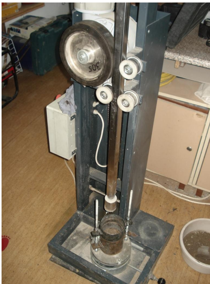
Obrázek 17 Hutnění směsí Proctorovou modifikovanou energií
