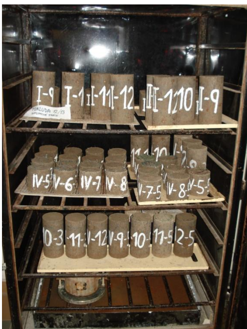
Obrázek 20 Zrání vzorků za stálé vlhkosti
