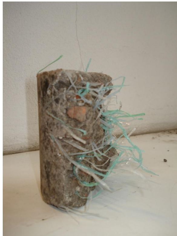
Obrázek 25 Rovina porušení vzorku
