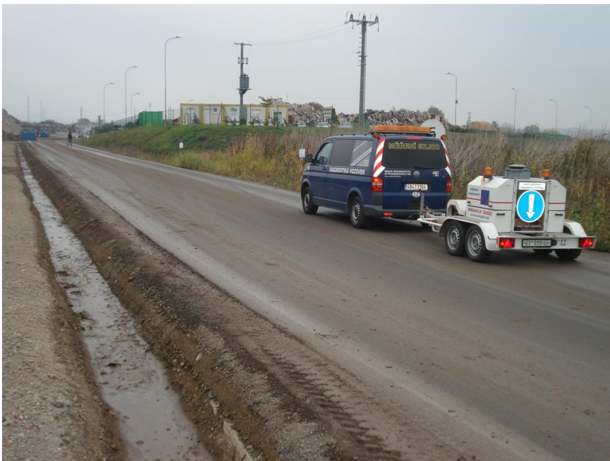
Obrázek 31 Měření únosnosti na zkušebním polygonu
