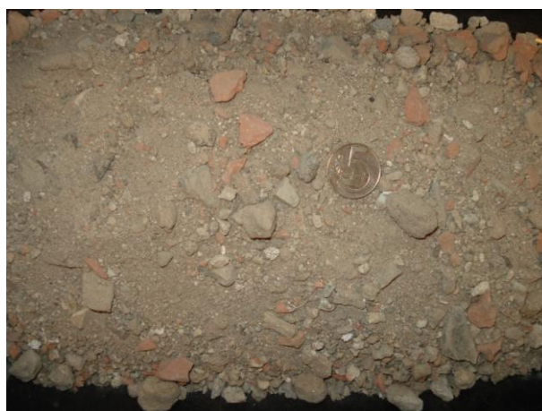
Obrázek 13 Směsný recyklát frakce 0/16 mm
