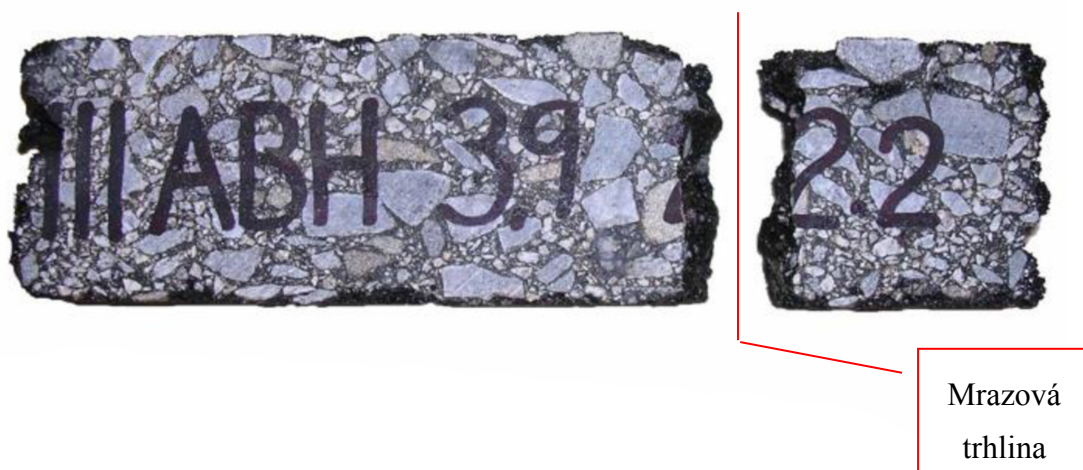
Obrázek 16: Porušení tělesa mrazovou trhlinou[9]
