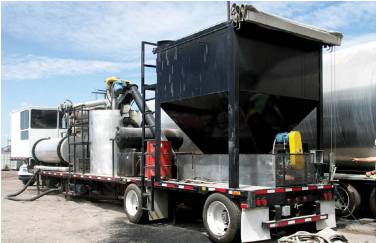
Obrázek 3: Míchací souprava ECOPATH pro přípravu gumoasfaltového pojiva [5]
