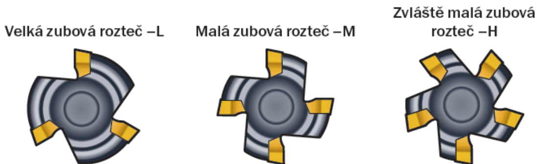
Obr. 6.3 Nerovnoměrná zubová rozteč nástrojů firmy Sandvik Coromant [21]
