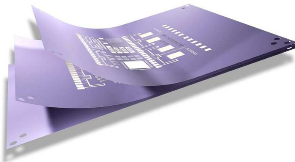
Obr. 1.: Struktura základního materiálu LTCC[3]
