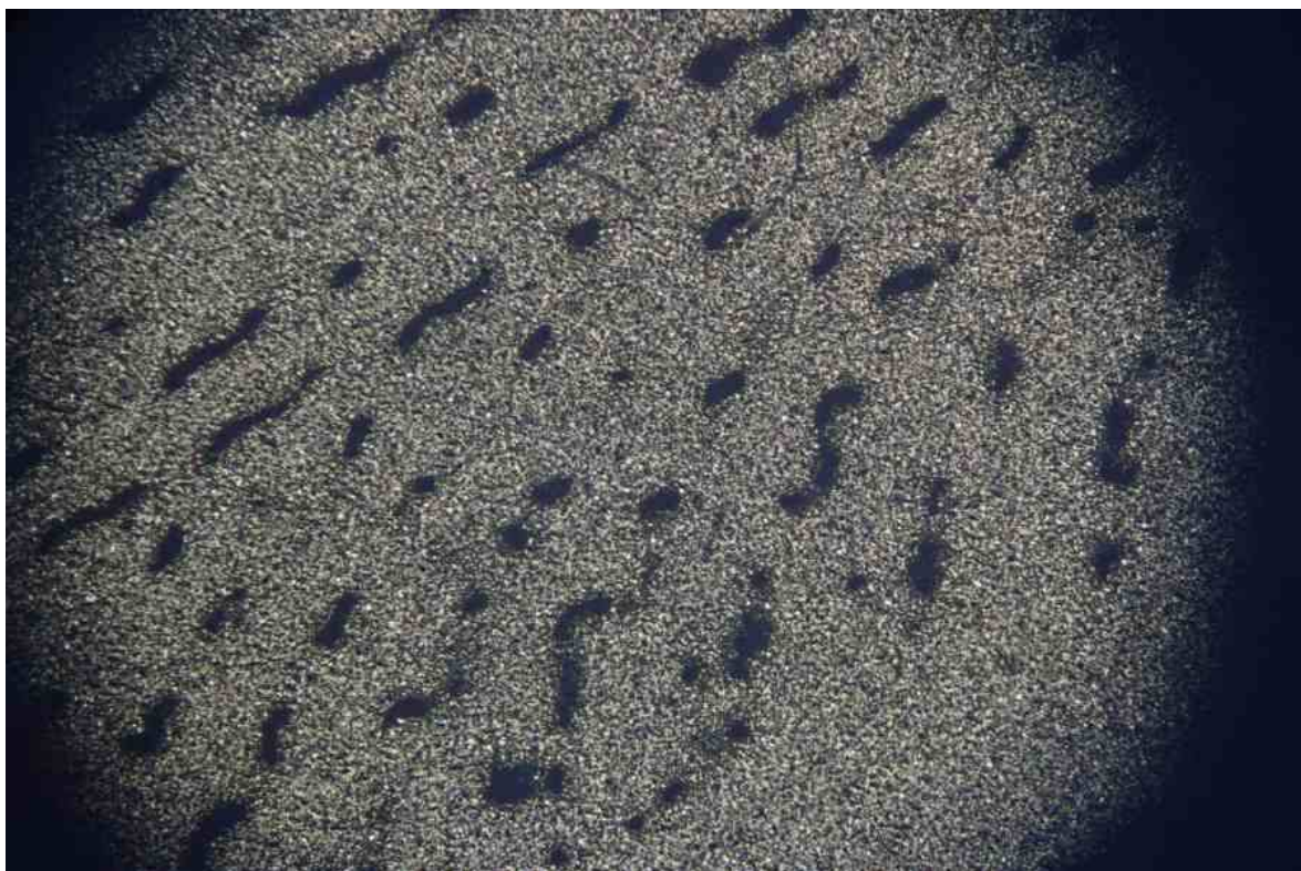
Obr. 29.: Nejhůře natištěná vrstva na LTCC, pod úhlem 45°, pasta TC 0306 po výpalu
