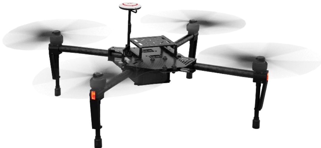
Obrázek 1.1 Dron DJI Matrice 100 s originální elektronikou od výrobce, zdroj: [2]
