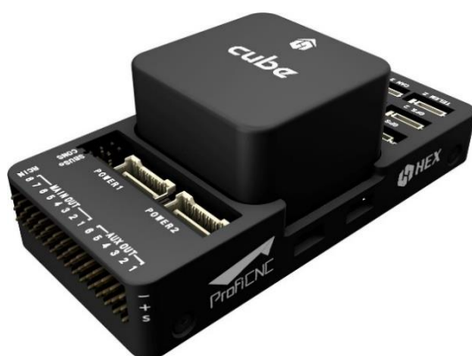
Obrázek 1.2 Řídicí jednotka pro drony, Cube – Pixhawk 2.1, zdroj: [8]
