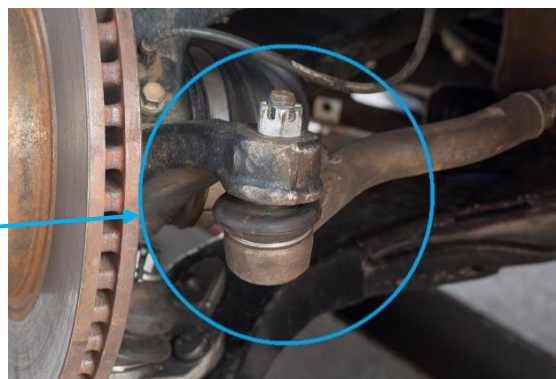
Obr. 3 Uložení čepu v nápravě automobilu [7].
