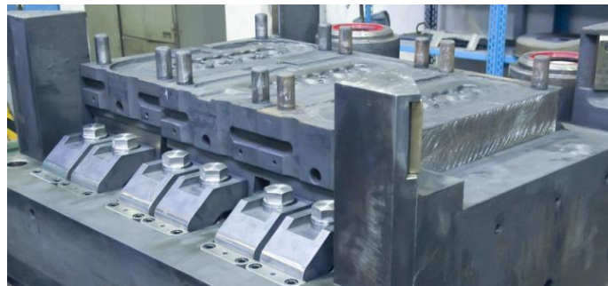
Obr. 28 Ustavení zápustkových bloků v držáku [29].
