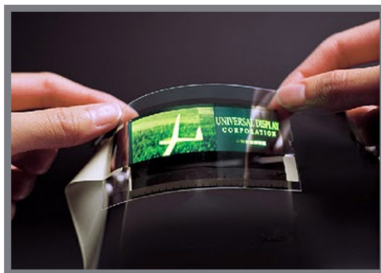
Obr. 11 Ukázka FOLED displeje, [23]
