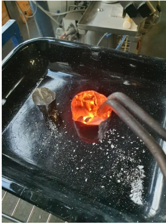
Obr. 11: Vzorek v platinovém kelímku vyjmutý z pece
