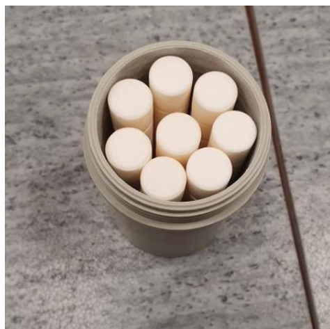
Obr. 8: Korundová tělíška v mlecí kapsli mlýnu McCrone
