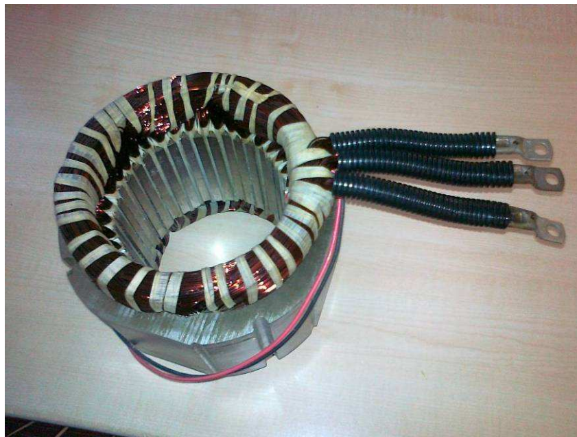
Obr. 70 – Pohled na hotový prototyp statoru TSP112/4 se zkrácenými mezifázovými zuby
