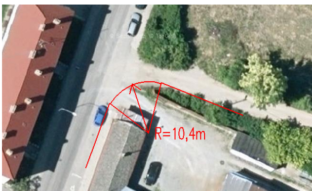
Obr. 25 - Křížení ulice Svatopluka Čecha a příjezdu na stavenišť[4]
