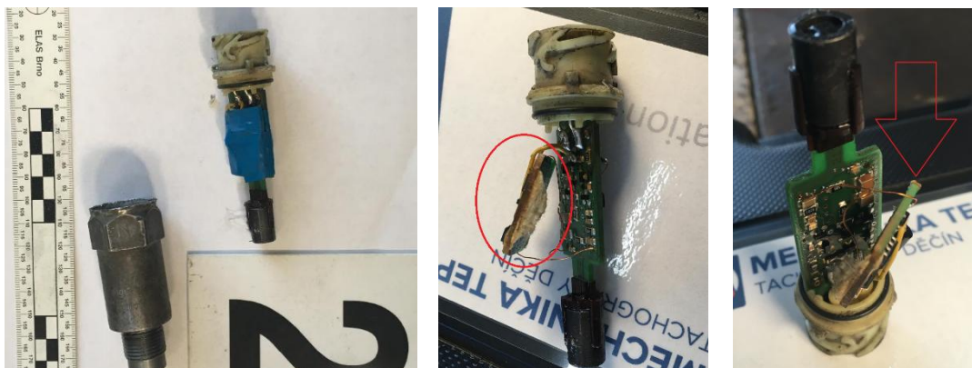
Obrázek č. 6 - Odstranění krytu snímače (autor)
