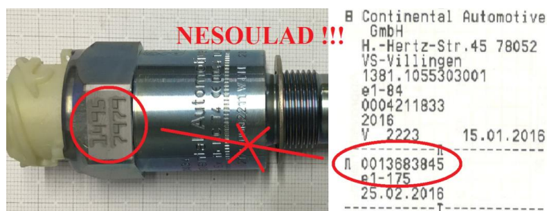
Obrázek č. 1 - Kontrola snímače pohybu (autor)
