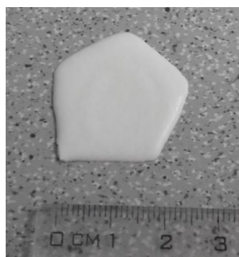
Obrázek 22. Tvar pětiúhelníku vyrobený přímým tiskem
