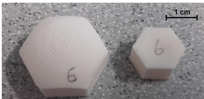
Obrázek 21. Ukázkový vzorek odlitku z formy 1 (vpravo) a z formy 2 (vlevo)
