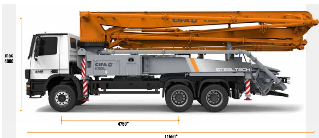
Obrázok 35 Mobilné čerpadlo Cifa K38 L (20)
