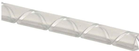
Obr. 19: Trubka na rozvod živice vo forme.
