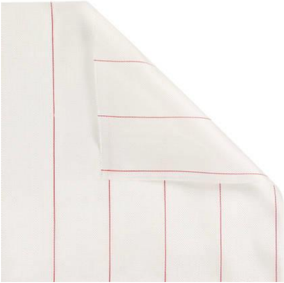
Obr. 21: Látka použitá na oddelenie rozvodného systému od vzorku.
