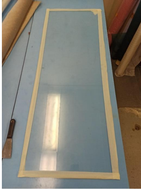
Obr. 16: Sklenená tabuľa ktorá slúži ako forma oblepená papierovou páskou.
