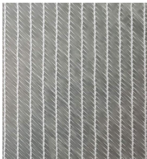
Obr. 15: Sklené vlákno s textúrou bi-axial.
