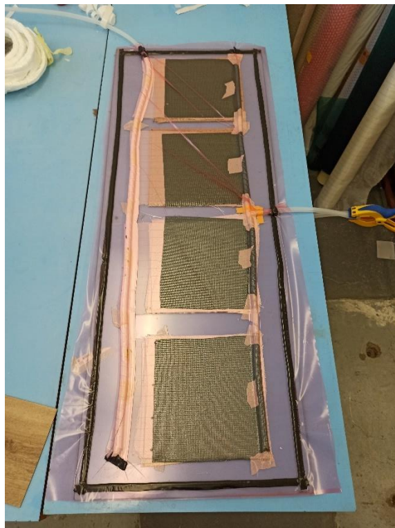
Obr. 24: Vzorky vo vákuu pripravené na infúziu živicom.
