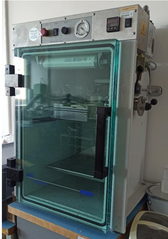
Obr. 26: Vákuová komora použitá na odstránenie bublín zo živice.
