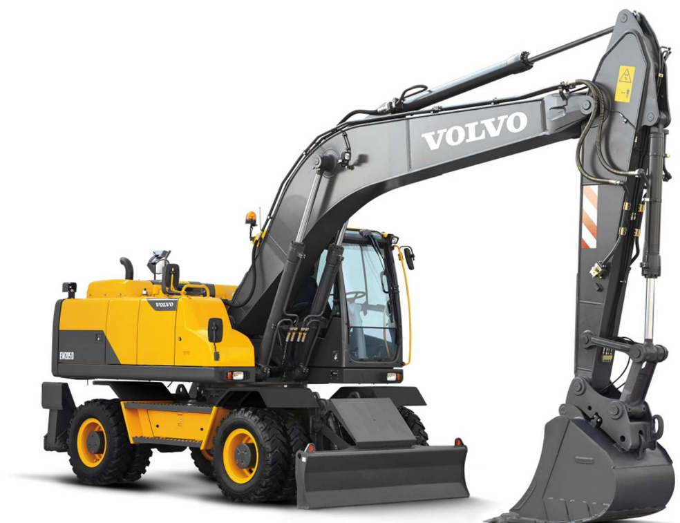
Obr. 3.5 Kolové rypadlo Volvo EW 205D s jednou říditelnou nápravou [5]
