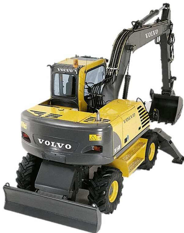
Obr. 1.2 Kolové rypadlo Volvo EW 160B s dozerovou radlicí a sklápěcími opěrami [5]
