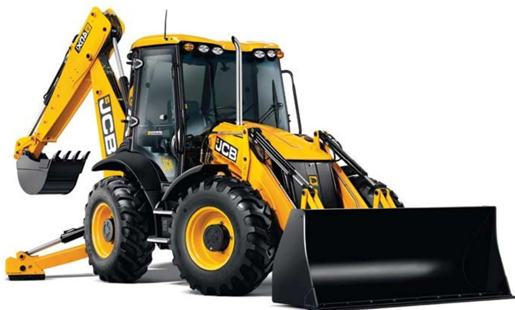
Obr. 3.7 Rypadlo-nakladač JCB 4CX se dvěma říditelnými nápravami [30]
