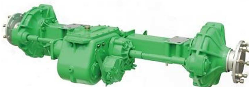
Obr. 2.10 Hydrostaticky poháněná náprava [18]
