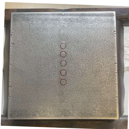
Obrázek 4.3 Vzorek s vyznačenou polohou termočládků
