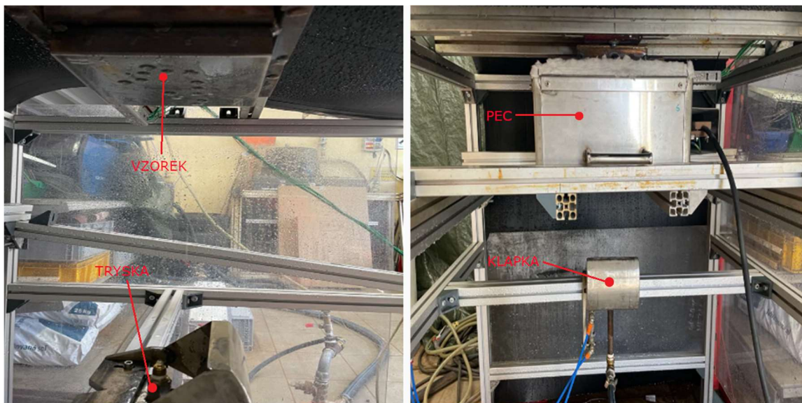
Obrázek 4.2 Uchycení vzorku, pece a trysky na experimentálním zařízení
