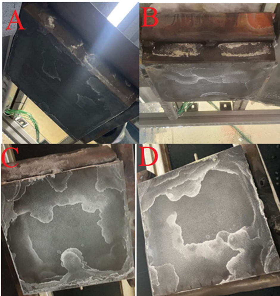
Obrázek 4.22 Povrch vzorku po chlazení směsí vody a soli, A) 1 % koncentrace soli, B) 5 % koncentrace soli, C) 10 % koncentrace soli, D) 12 % koncentrace soli
