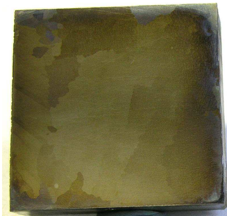
Obr.4.15 Vzorek 1-3 makroskopická struktura oceli 30CH3N17G2L
