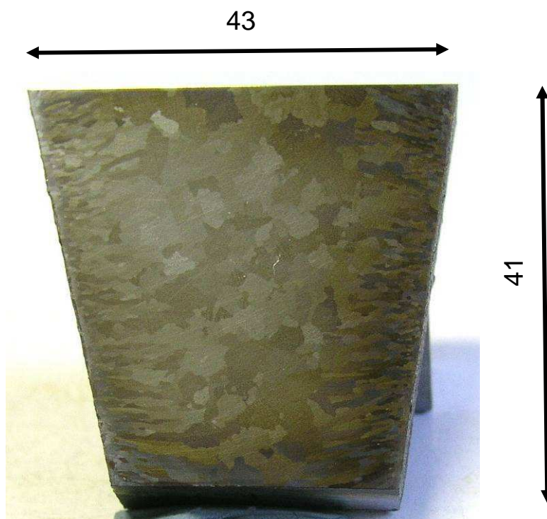
Obr.4.17 Vzorek 2-1 makroskopická struktura oceli 30CH3N17G2L
