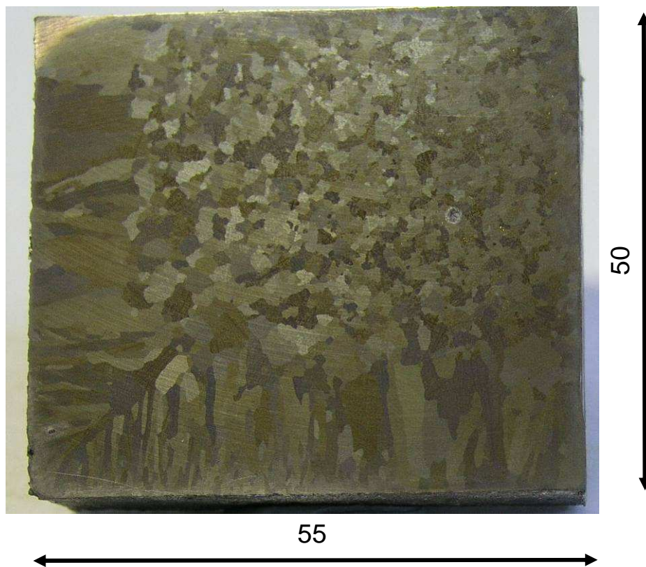
Obr.4.20 Vzorek 2-4 makroskopická struktura oceli 30CH3N17G2L
