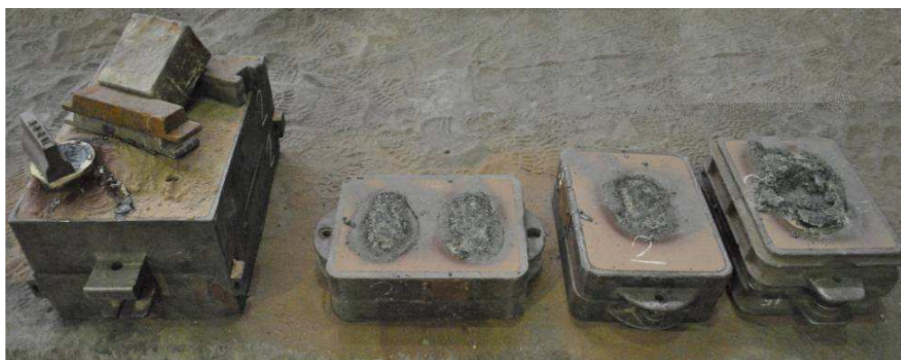
Obr.4.9 Licí pole - odlitá zkušební sada odlitků č.2
