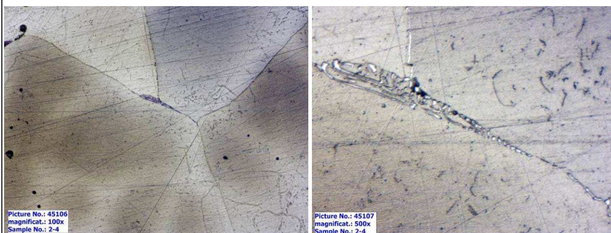
Obr.4.25 Vzorek 2-4 mikrostruktura oceli 30CH3N17G2L (zvětšení 100x a 500x)
