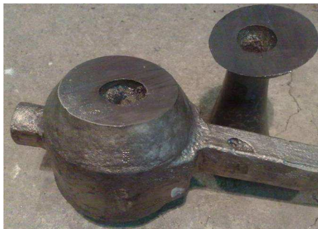
Obr.4.12 Rozříznutá staženina, Technologický odlitek č. 5
