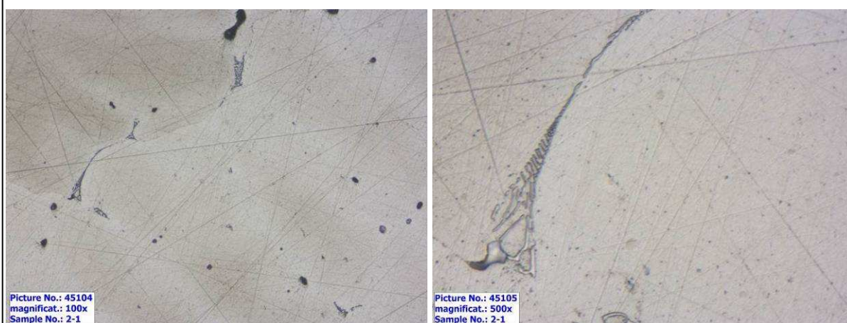
Obr.4.24 Vzorek 2-1 mikrostruktura oceli 30CH3N17G2L (zvětšení 100x a 500x)
