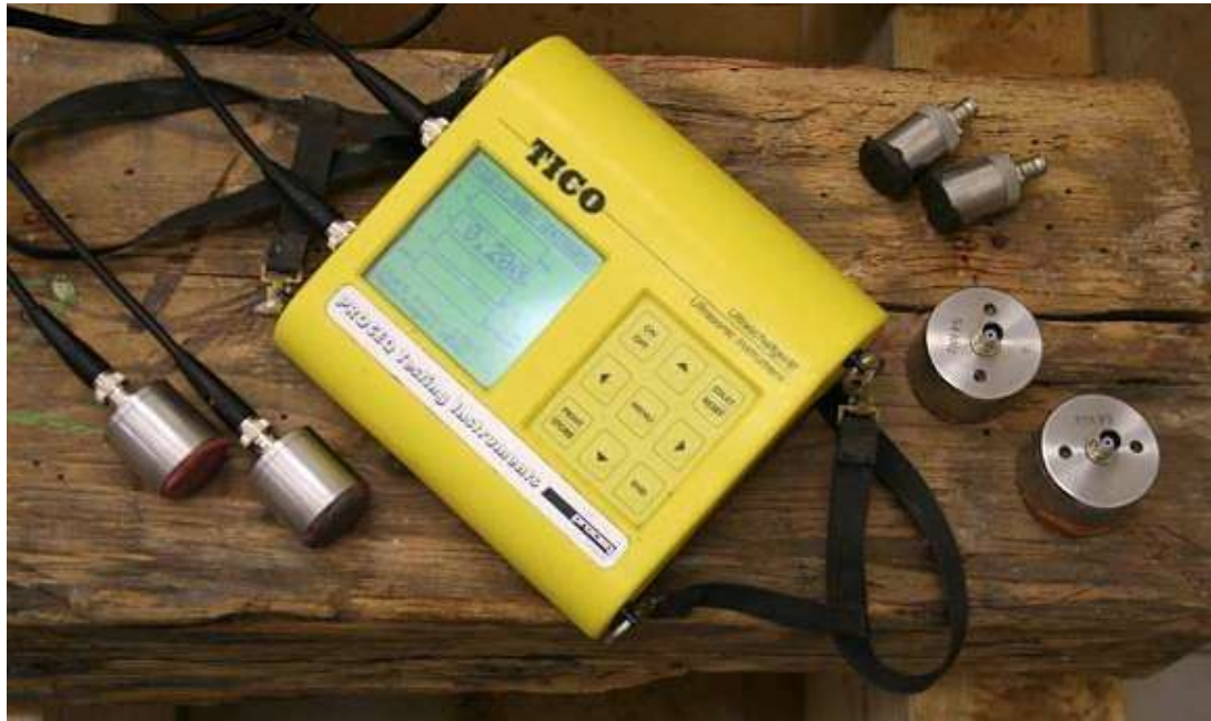
Obr.35 – Příklad pro měření rychlosti šíření ultrazvukových vln. [12]
