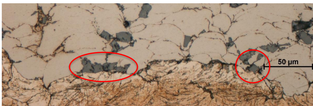
Obr. 27 částice SiC na rozhraní 2 nástřiků
