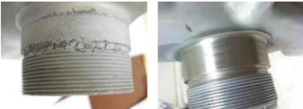
Obr. 12. ukázka opravy součástky pomocí CS [19]
