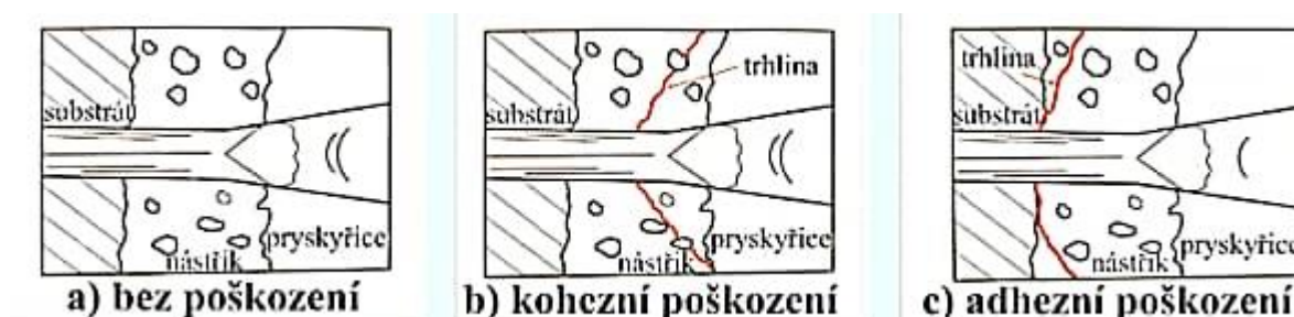
Obr. 20 schéma možných druhů poškození [30]
