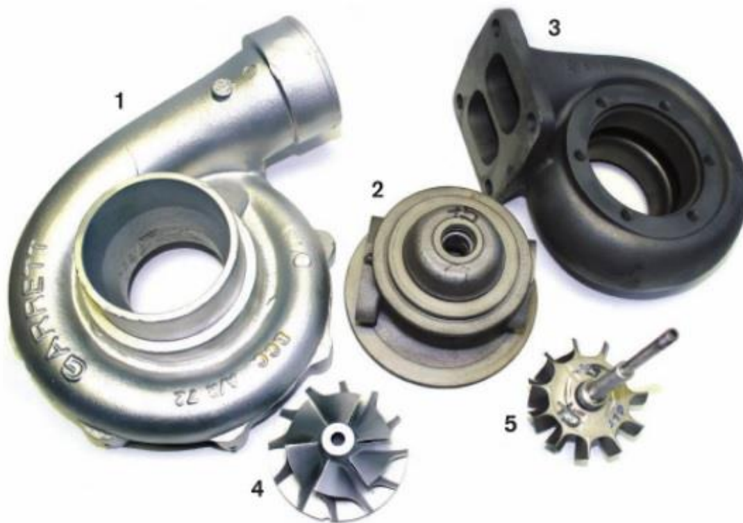
Obr. 5.2 Hlavné časti turbodúchadla [4].
