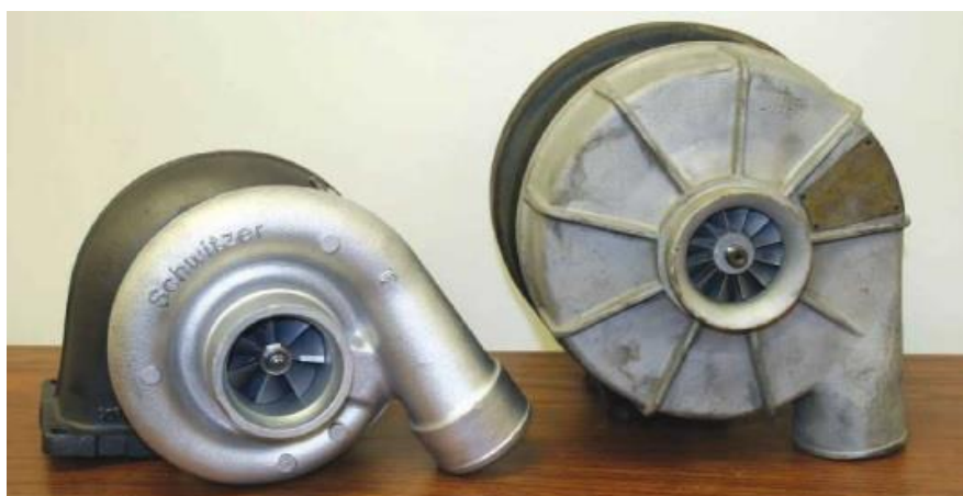
Obr. 1.1 Model Schwitzer-BorgWarner S3 (vľavo) a starší model turba zo 60tych rokov (vpravo) [3].
