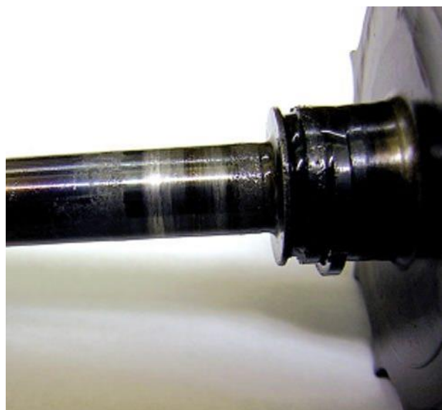
Obr. 6.5 Poškodenie hriadeľa z dôvodu vypnutia horúceho nedochladeného turbodúchadla [52].
