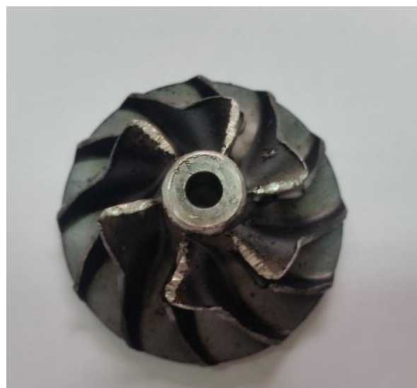
Obr. 6.2 Poškodenie lopatiek turbínového kolesa [50].
