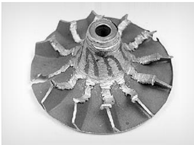
Obrázok 6.3 Poškodenie lopatiek kompresorového kolesa [52].
