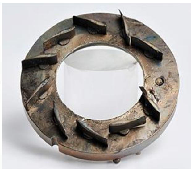
Obr. 6.1 Poškodenie lopatiek s premenlivou geometriou [52].
