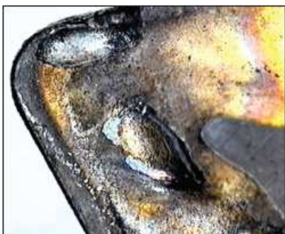
Obr. 1.9 Výmol na čele [6].
