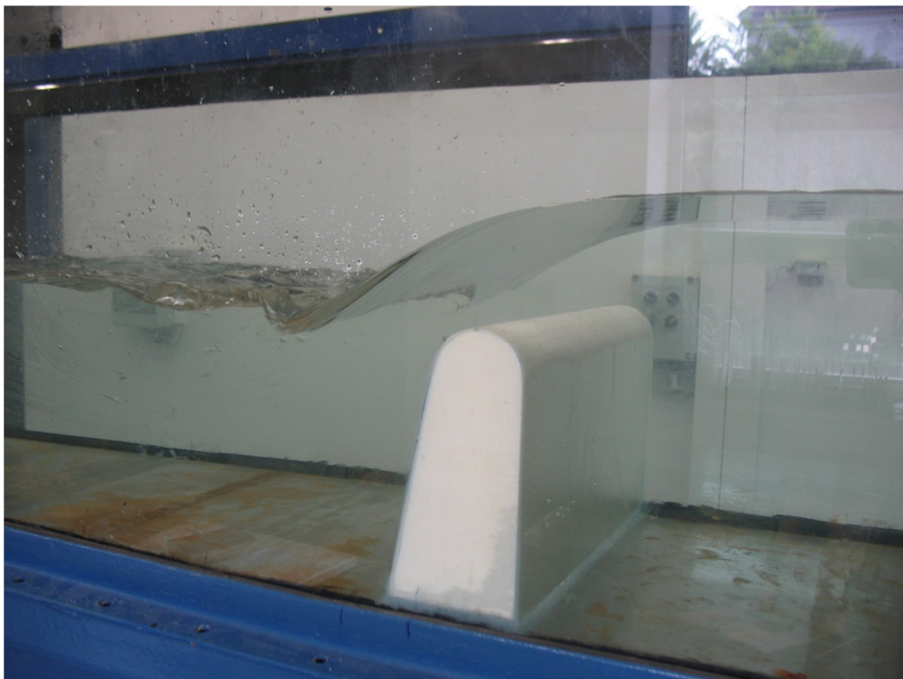
Obrázek 63 - Q = 20 \text{ l/s} , h = 77 \text{ mm} , h_z = 21 \text{ mm}
