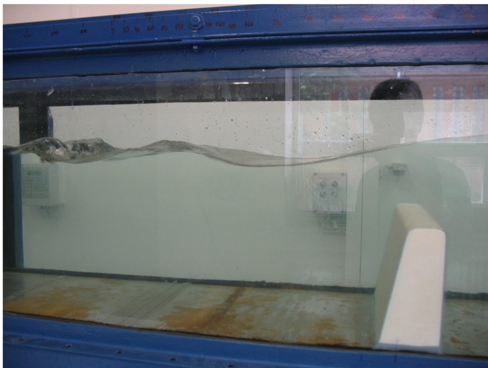
Obrázek 60 - Q = 30 \text{ l/s} , h = 132 \text{ mm} , h_z = 107 \text{ mm}
