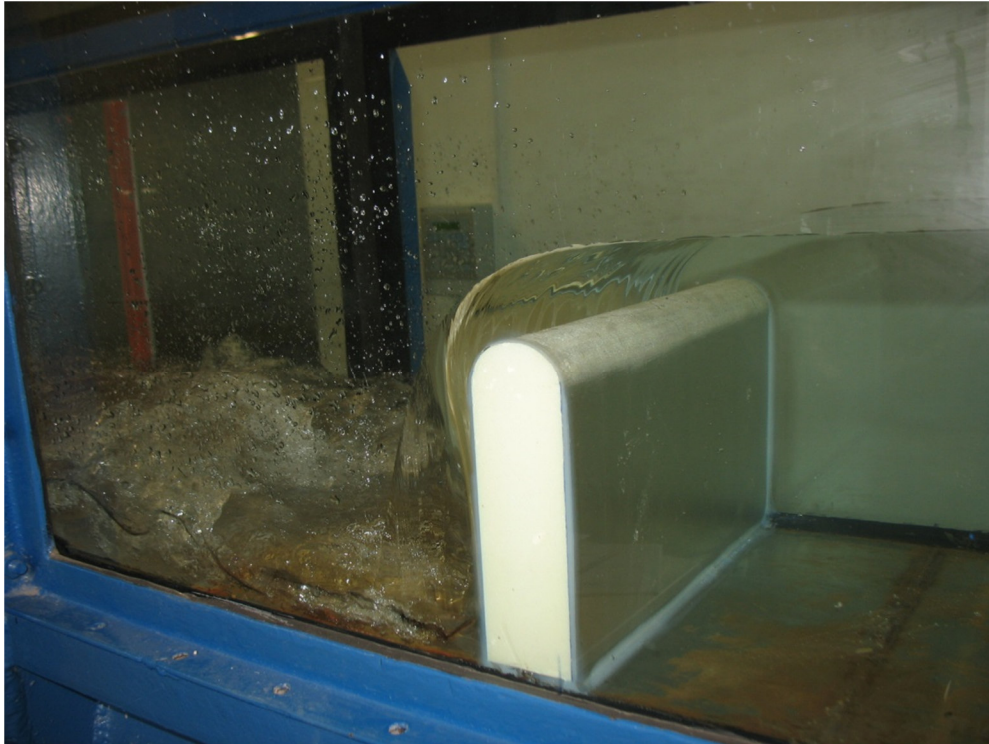
Obrázek 34 - Q = 10 \text{ l/s} , h = 48 \text{ mm} , h_z = 0 \text{ mm}
