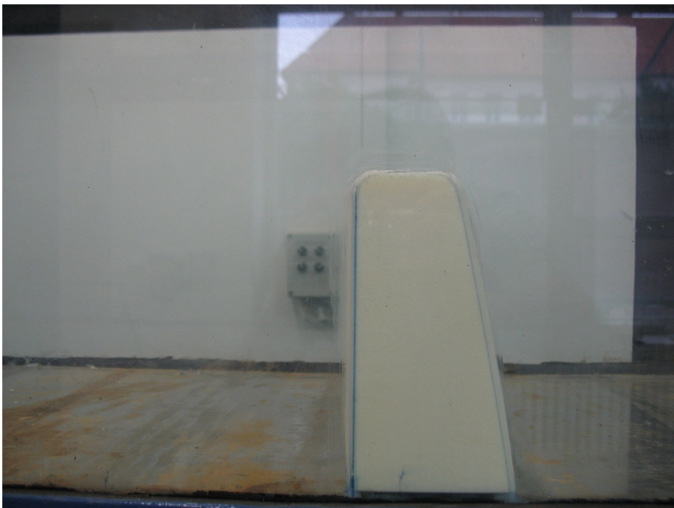
Obrázek 30 – Přeliv lichoběžníkového průřezu - 3. typ
