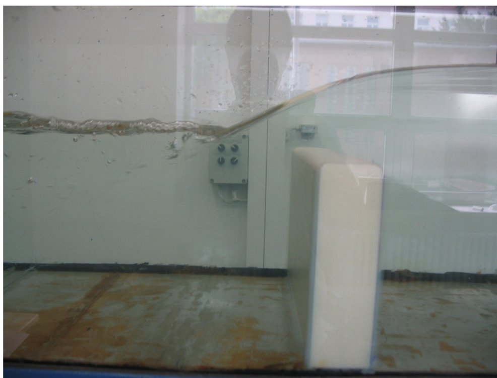
Obrázek 43 - Q = 20 \text{ l/s} , h = 83 \text{ mm} , h_z = 38 \text{ mm}
