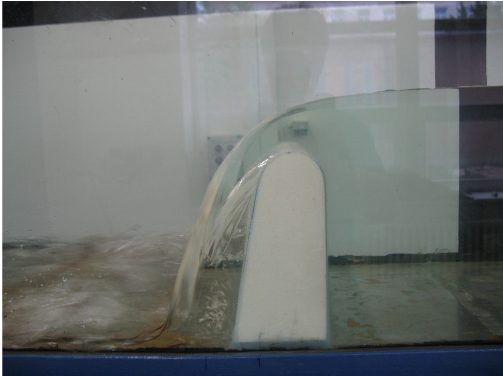
Obrázek 62 - Q = 10 \text{ l/s} , h = 49 \text{ mm} , h_z = 0 \text{ mm}
