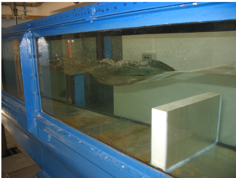
Obrázek 40 - Q = 25 \text{ l/s} , h = 111 \text{ mm} , h_z = 74 \text{ mm}
