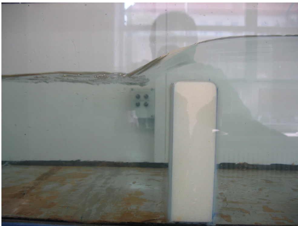
Obrázek 27 – Přeliv obdélníkového průřezu se zaoblenými hranami
