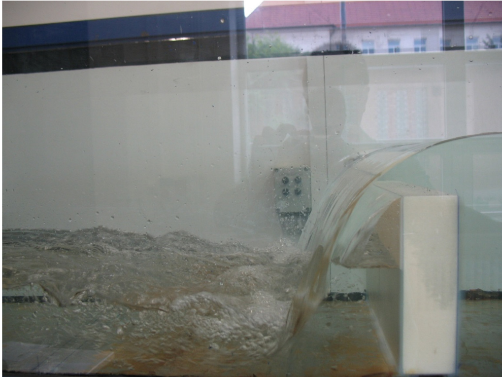
Obrázek 38 - Q = 10 \text{ l/s} , h = 57 \text{ mm} , h_z = 0 \text{ mm}
