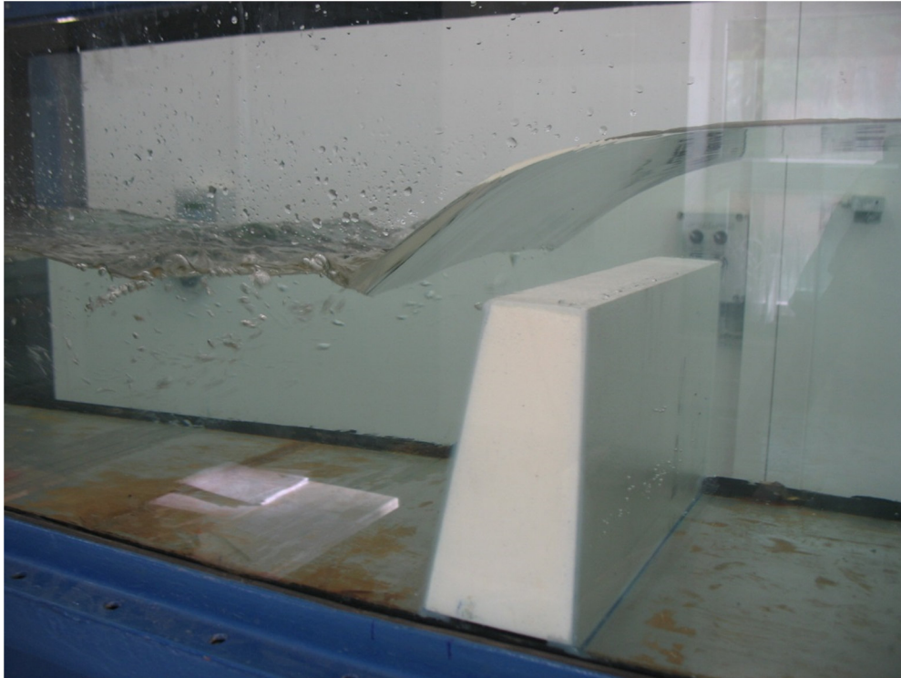
Obrázek 50 - Q = 20 \text{ l/s} , h = 85 \text{ mm} , h_z = 23 \text{ mm}
