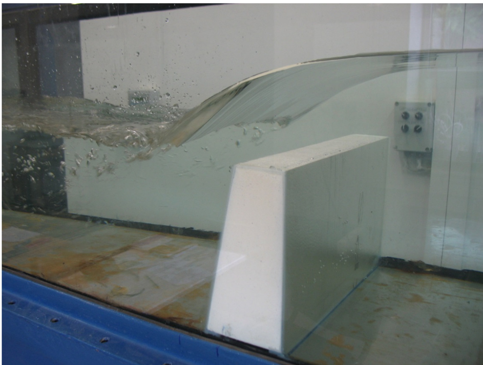
Obrázek 51 - Q = 25 \text{ l/s} , h = 97 \text{ mm} , h_z = 38 \text{ mm}
