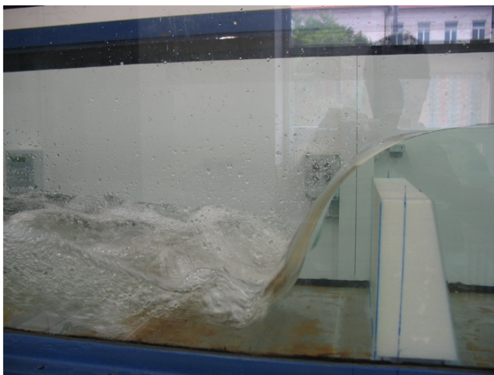
Obrázek 47 - Q = 20 \text{ l/s} , h = 81 \text{ mm} , h_z = 0 \text{ mm}
