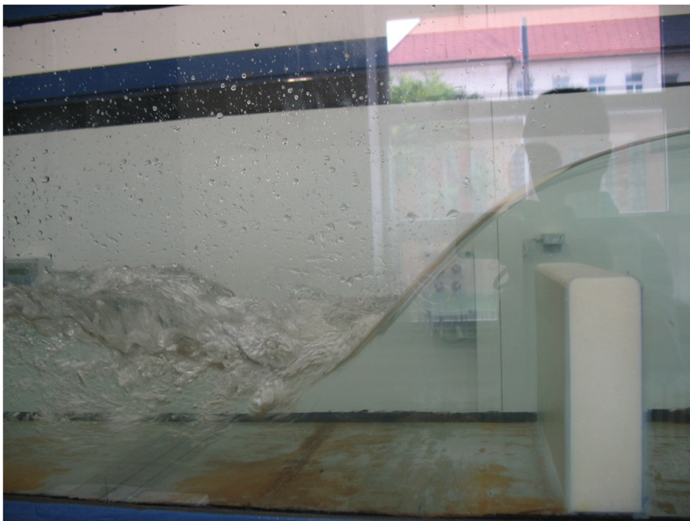
Obrázek 45 - Q = 35 \text{ l/s} , h = 109 \text{ mm} , h_z = 0 \text{ mm}
