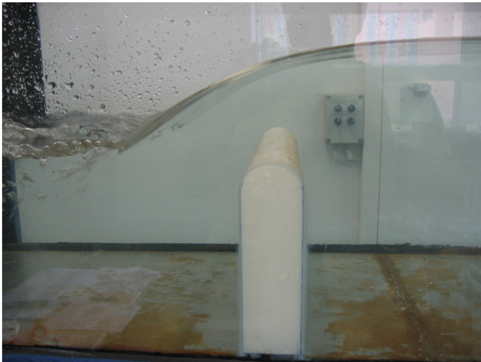
Obrázek 25 – Přeliv obdélníkového průřezu s kruhově zaoblenou korunou
