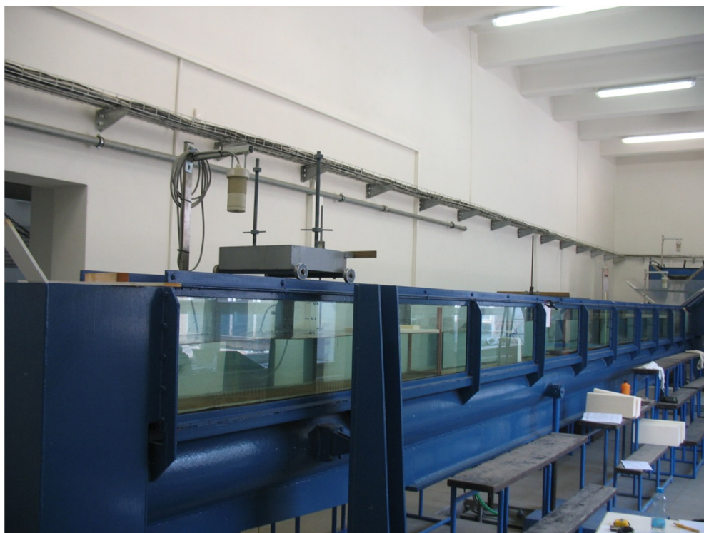
Obrázek 24 - Hydraulický žlab v budově F
