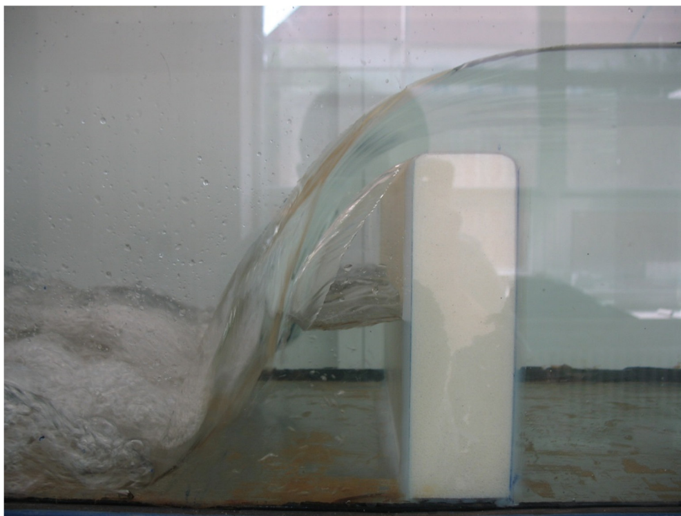
Obrázek 42 - Q = 10 \text{ l/s} , h = 53 \text{ mm} , h_z = 0 \text{ mm}
