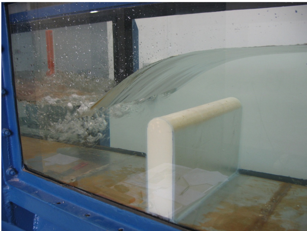
Obrázek 37 - Q = 35 \text{ l/s} , h = 109 \text{ mm} , h_z = 32 \text{ mm}
