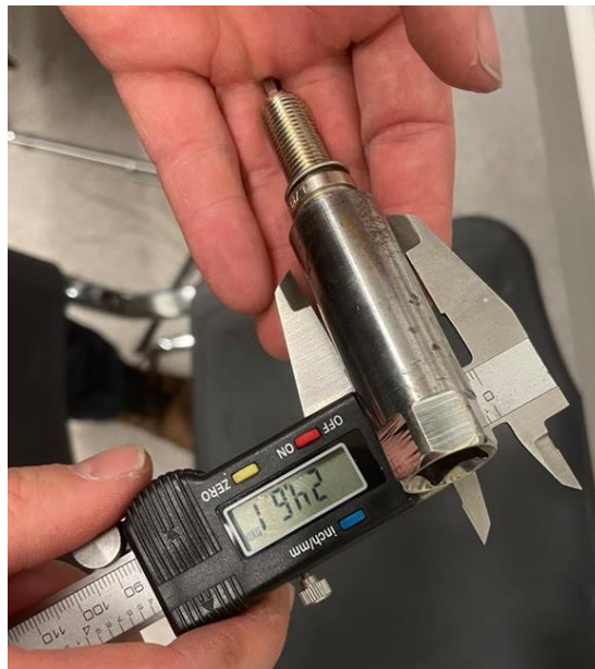
Obr. 14 Meranie rozmeru sviečky posuvným meradlom
