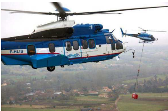
Obrázek 32: Vrtulník EC 225 s nosností 3500 kg, převzato z [130].
