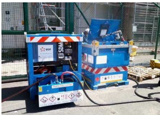
Obrázek 28: Mobilní palivové čerpadlo o průtoku až 3,6 m 3 /h a mobilní nádrže o objemu 600 l a hmotnosti 600 kg a 1000 kg, převzato z [130].
