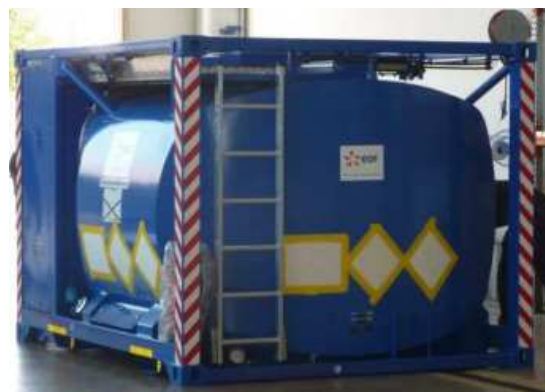
Obrázek 27: Mobilní čerpací stanice o průtoku až 36 m 3 /h a hmotnosti 8000 kg, převzato z [130].
