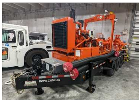
Obrázek 39: Čerpadlo z artézské studny pro parogenerátor elektrárny Turkey Point na Floridě. Slouží k doplňování nádrže vodou ze studny za účelem dodání vody do parogenerátoru, převzato z [146].
