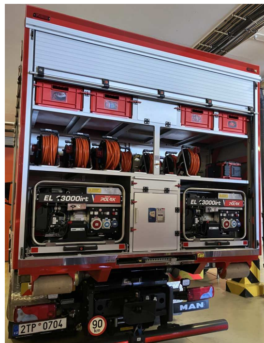
Obrázek 14: Elektrické centrály na napájení mobilních čerpadel na ETE.
