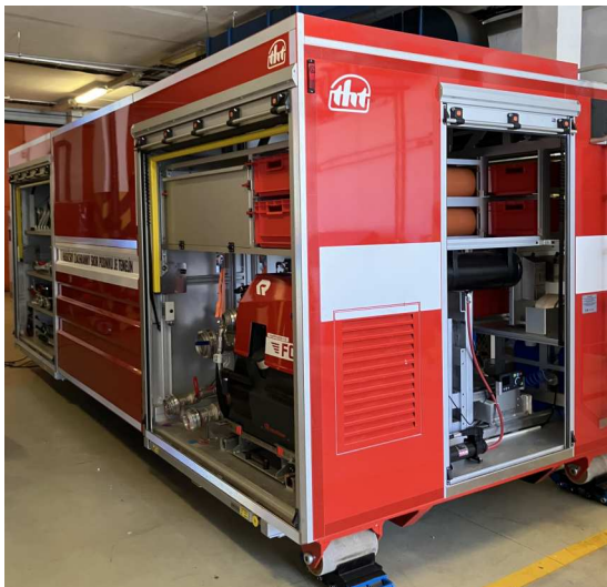
Obrázek 17: Kontejner s mobilním čerpadlem (viz obr. 16), nádrží o objemu 5 m 3 a dalším hasičským vybavením pro čerpání na ETE.
