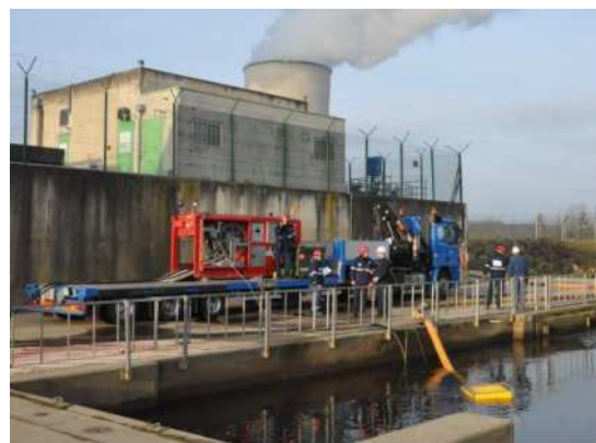
Obrázek 29: Mobilní čerpadlo s průtokem 210 m 3 /h a tlakem až 10 bar s hmotností 3500 kg, které je přivezeno na valník tahače, převzato z [130].
