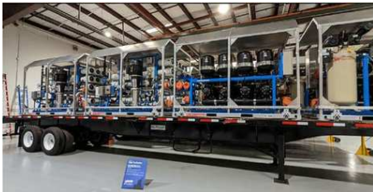
Obrázek 37: Zařízení na čištění vody, umístěné v Národním centru ve Phoenixu v Arizoně, je navrženo tak, aby umožňovalo využití kvalitnější vody pro doplňování chladicího systému reaktoru, převzato z [146].
