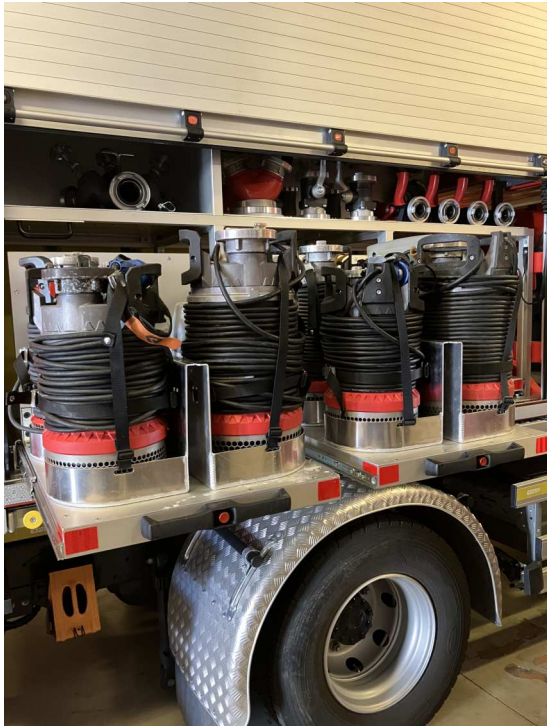
Obrázek 15: Elektrická mobilní čerpadla na ETE.
