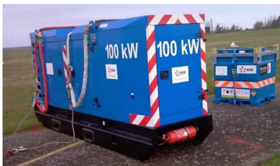
Obrázek 26: Mobilní EDG o výkonu 100 kW a hmotnosti 3500 kg. Pro každý reaktor jsou potřeba dvě zařízení, převzato z [130].
