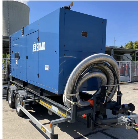
Obrázek 20: Mobilní dieselgenerátor na ETE.
