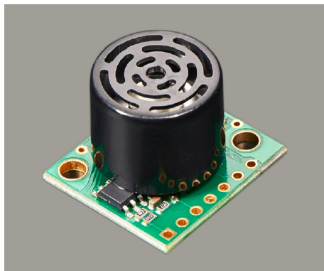
Obr. 3.4: Ultrazvukový snímač vzdialenosti s jedným piezoelektrickým transducerom [12]
