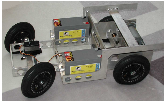
Obr. 1.2: Foto rámu Bendra 2 s akumulátormi a jedným DC motorom [13]
