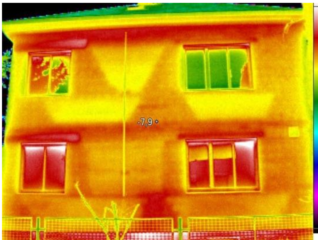
Obr. 2 Úniky energií - thermokamera
