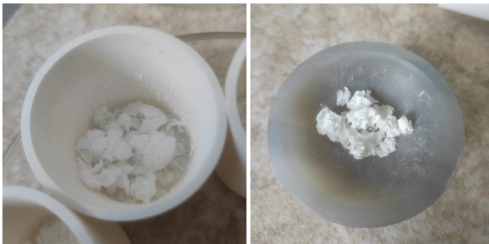
Obrázek 5.9 Sodný titanát vzorku č. 5 v žíhací misce po výpalu (vlevo) a v achátové misce před rozemletím (vpravo).
