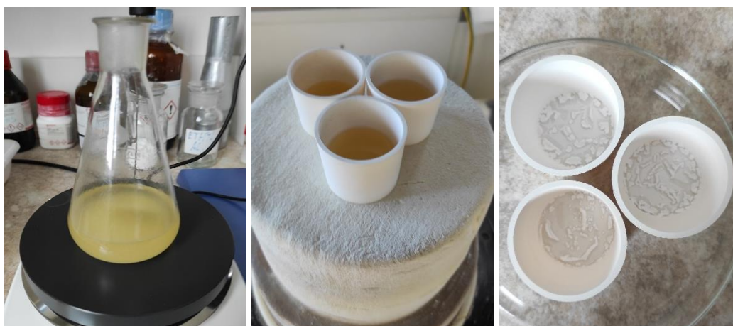
Obrázek 5.2 Koloidní suspenze na hot-plate (vlevo), suspenze v žíhacích miskách v peci před výpalem (uprostřed), sodný titanát v žíhacích miskách těsně po výpalu (vpravo).
