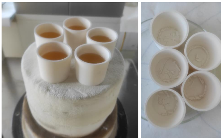
Obrázek 5.6 Suspenze vzorku č. 3 v žíhacích miskách před výpalem (vlevo) a po výpalu (vpravo).
