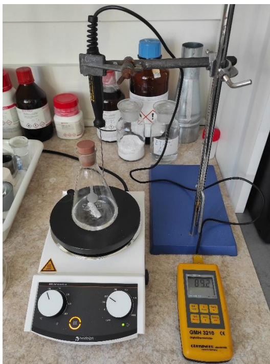
Obrázek 5.1 Pracoviště pro přípravu koloidní suspenze.
