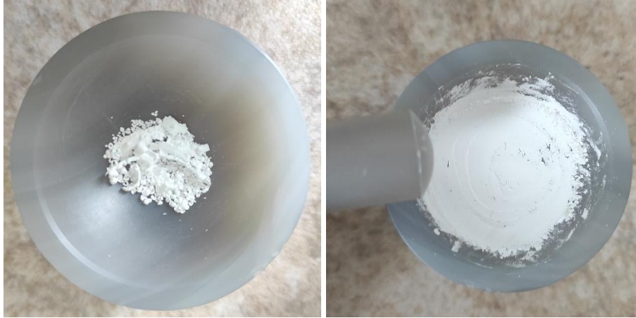
Obrázek 5.3 Sodný titanát v achátové misce před (vlevo) a po rozemletí (vpravo).
