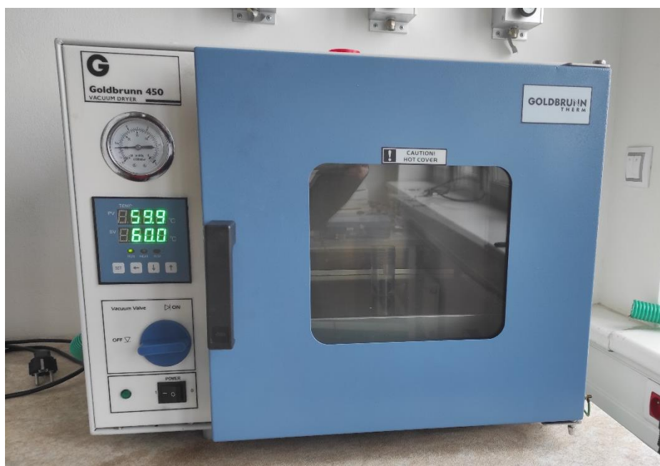
Obrázek 5.11 Vakuová sušička GOLDBRUNN použitá k vysušení elektrod.
