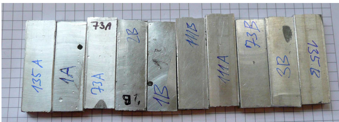
obr. 4 Odebrané části reálných odlitku pro tahovou zkoušku.
