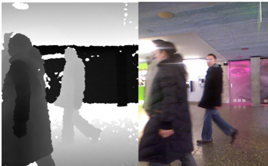
Obrázek 4.4: Příklad trénovacích dat [1][2] vlevo je hloubkový obraz, vpravo je frame z RGB kamery
