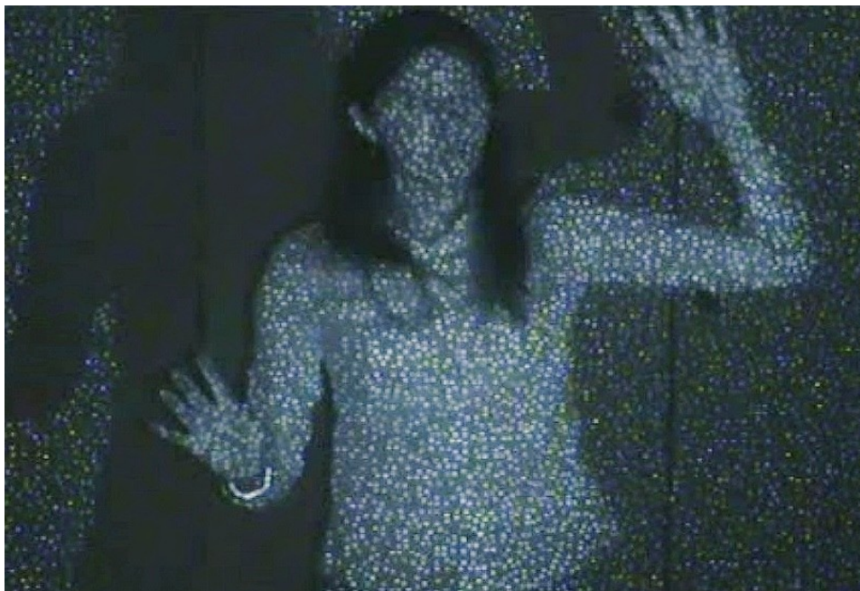
Obrázek 2.3: Příklad mračna bodů vyslaných Kinectem (převzato z [16])
