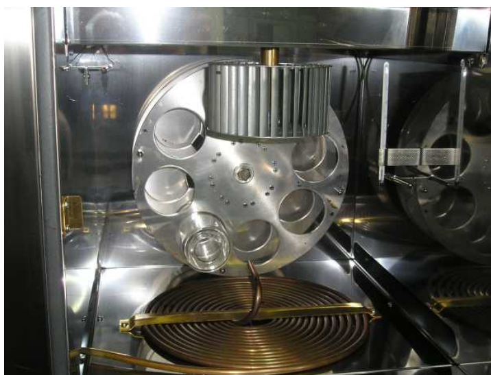
Obrázek 34: Držák pro skleněné nádoby sušárny RTFOT [37]
