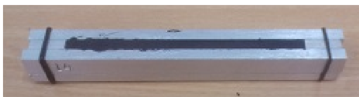
Obrázek 39: Forma pro zkušební tělesa na zkoušku BBR
