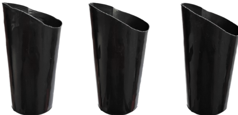
Obr. 31 Vzorky vyrobené při vstřikovacích rychlostech 90, 130, 200 mm.s -1
