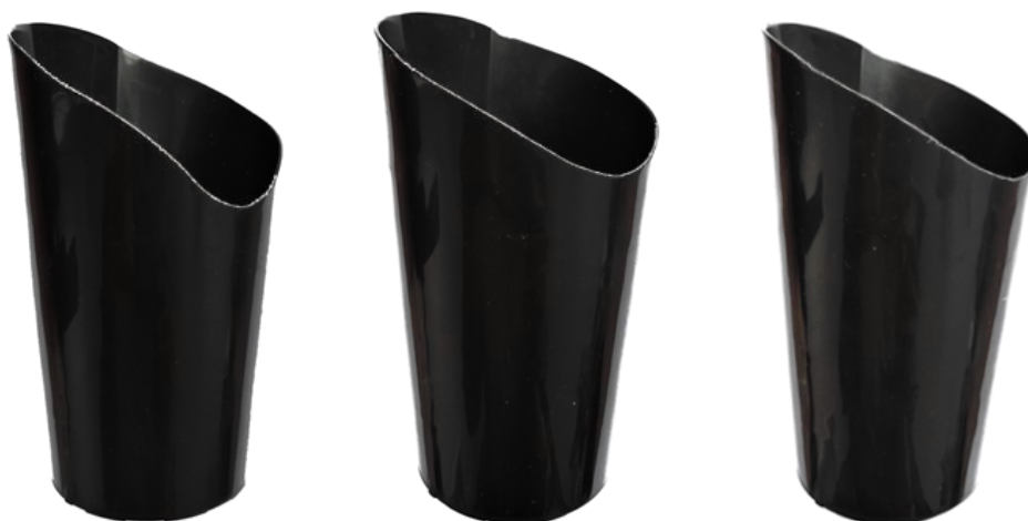
Obr. 30 Vzorky vyrobené při vstřikovacích rychlostech 20, 40 a 60 \text{ mm}\cdot\text{s}^{-1}
