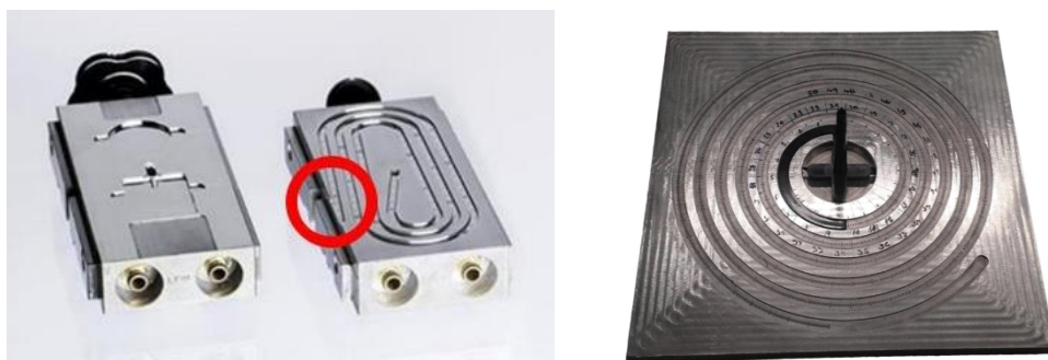
Obr. 21 Příklady spirálových forem [44]
