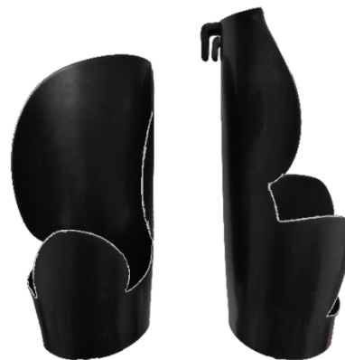
Obr. 29 Asymetricky naplněné díly
