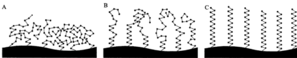
Obrázek č. 8: Průběh aktivace vázaných fází sorbentu: A) inaktivovaný sorbent, B) částečná aktivace, C) plná aktivace [28]
