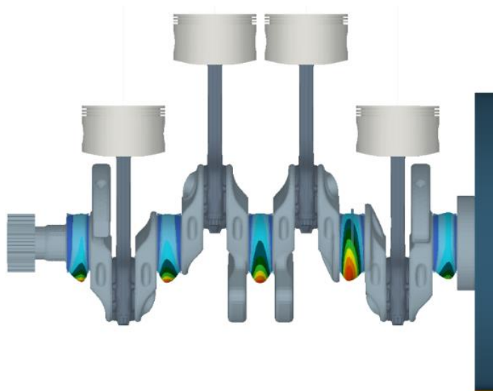
Obr. 100 Rozložení hydrodynamického tlaku u hlavních ložisek pro sekvenci J při 3000 \text{ min}^{-1}
