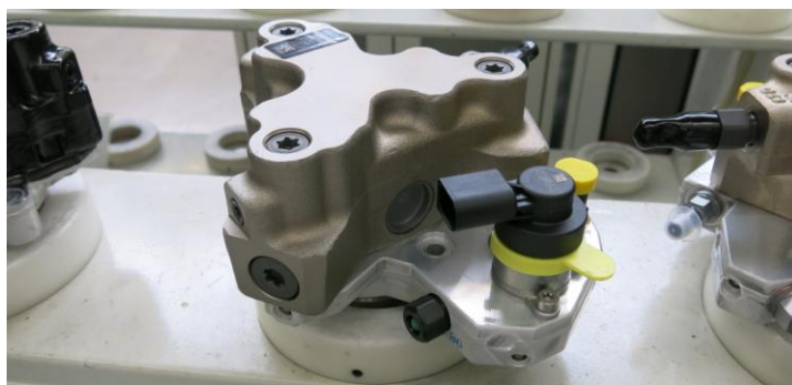
Obr. 20 Čerpadlo CP3 označené barevným prstencem
