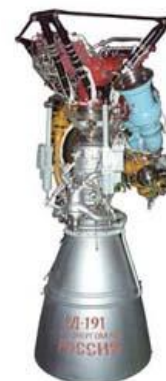
Obr. 29 Stupeň Bajkal (vľavo) [68], motor RD-191 (vpravo) [67]
