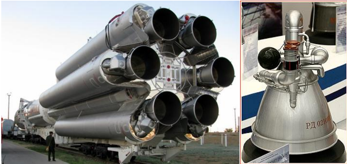
Obr. 23 Usporiadanie motorov prvého stupňa [43] (vľavo), motor RD-0210 (vpravo) [44]
