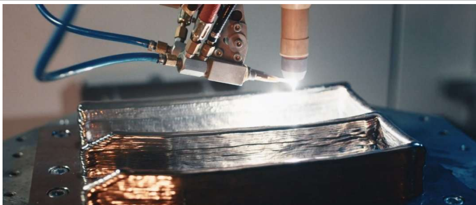
Obr. 8) Aditivní výroba pomocí plazmatu [15]
