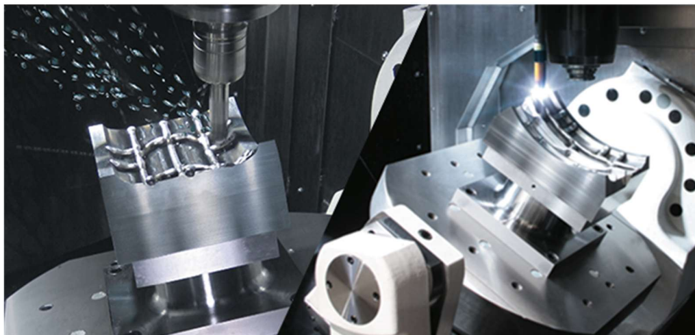
Obr. 1) Integrace aditivní výrobní technologie a víceúčelového obrábění [4]
