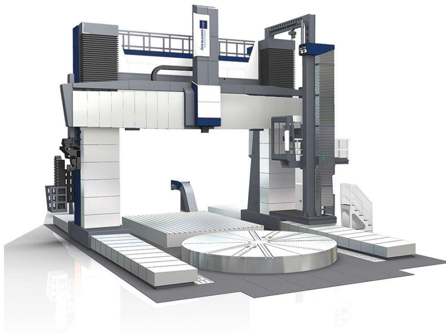
Obr. 5) Svislý soustruh ČKD SKDY [8]
