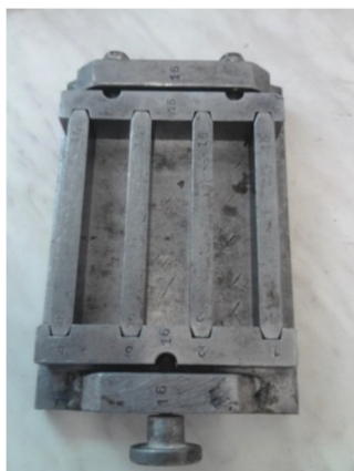
Obrázek 13 Ocelová forma 20×20×100 mm
