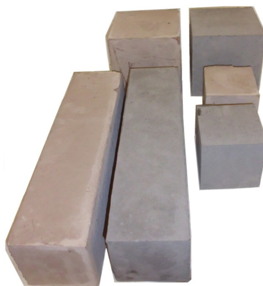
Obrázek 16 Vzorky betonových trámčů 10×10×40 cm a kostek 15×15×15 cm
