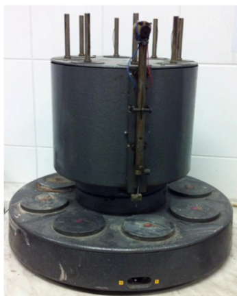
Obrázek 20 Vicatův přístroj (vyroben 1979)
