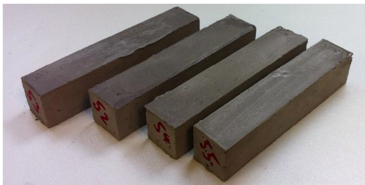
Obrázek 14 Zkušební vzorky 20×20×100 mm
