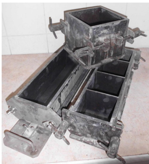
Obrázek 15 Formy trámčů 10×10×40 cm a kostek 15×15×15 cm
