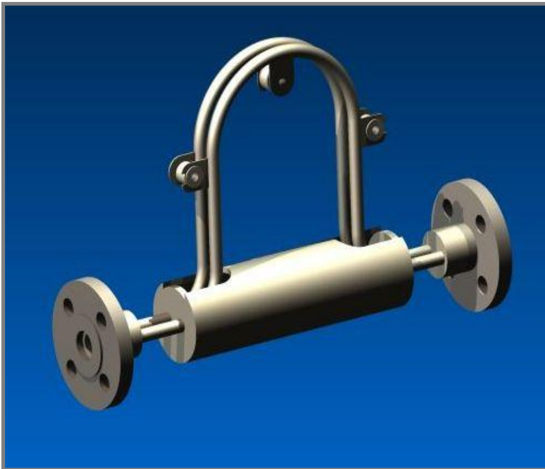
Obr. 5-8 Návrh měřících trubec a jejich upevnění
